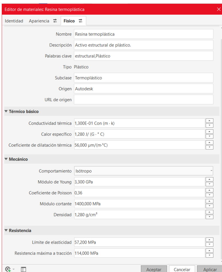
Figura 14. Características físicas y mecánicas del acrílico. Fuente: Autor.
