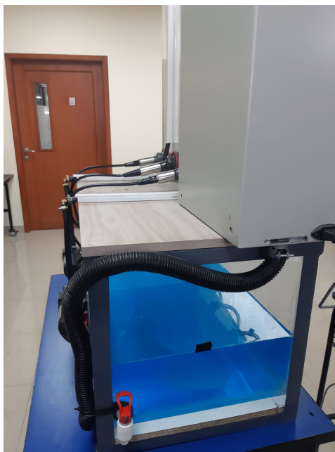
Figura 51. Válvula de desfogue del reservorio
