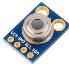
Figura 11. Sensor de temperatura infrarrojo MLX90614 [28]
