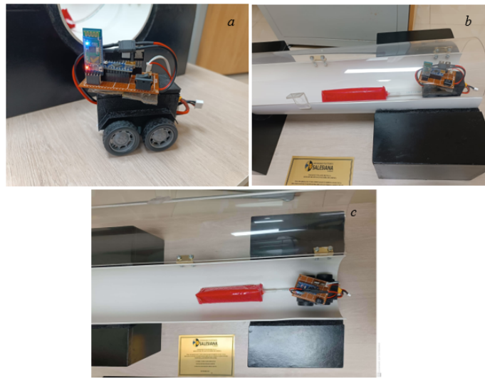
Figura 184. (a) Circuito final montado en la nueva base. (b) Cortes necesarios para el monitoreo del circuito [94].
