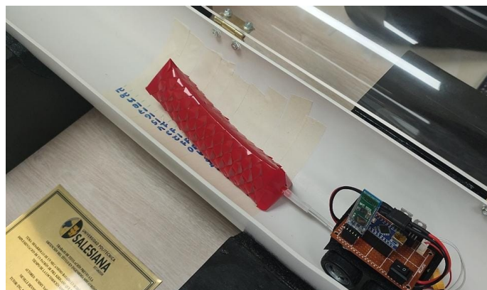
Figura 188. Actuador cubierto con una superficie kirigami que presenta un patrón triangular[95].
