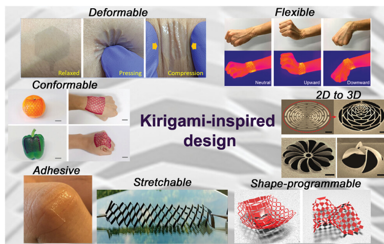
Figura 23. Algunas características sobresalientes que pueden ser conferidas a una variedad de materiales mediante la aplicación de cortes de diseño inspirados en el kirigami [47].
