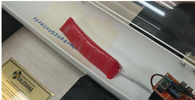
Figura 187. Actuador cubierto con una superficie kirigami que presenta un patrón lineal[95].
