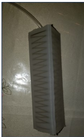
Figura 88. Se inserta la manguera dentro del actuador [62].
