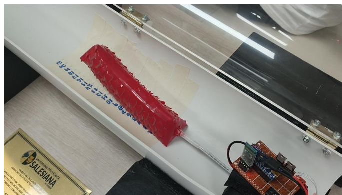
Figura 189. Actuador cubierto con una superficie kirigami que presenta un patrón trapezoidal[95].
