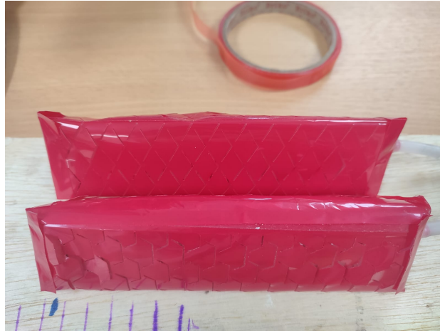
Figura 177. Revestimiento de la piel Kirigami con un patrón triangular y trapezoidal [92].
