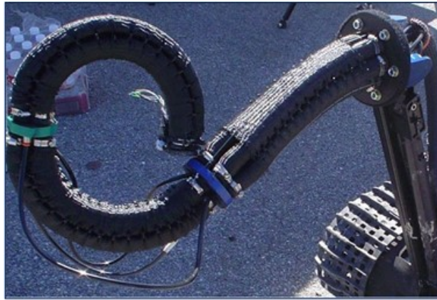
Figura 9. Manipulador continuo representativo OctArm [37].
