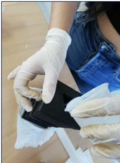
Figura 82. Vertido de silicona en el interior de los moldes [62].
