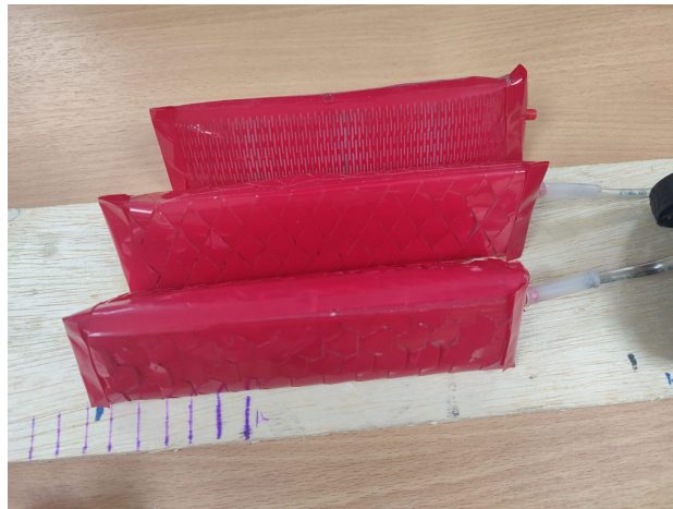
Figura 178. Revestimiento de la piel Kirigami con un patrón triangular, trapezoidal y lineal [92].
