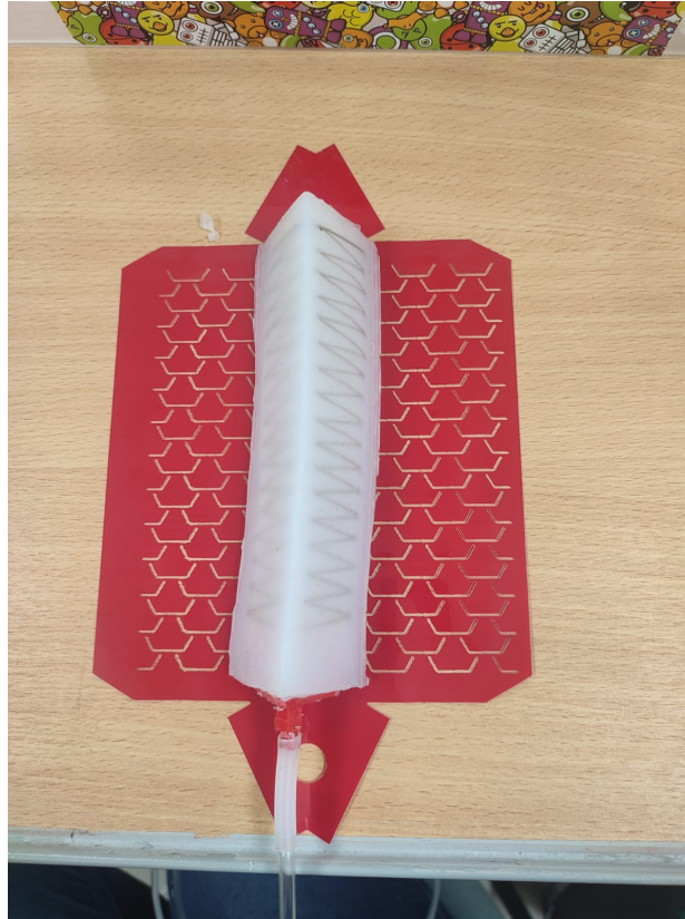
Figura 176. Revestimiento de piel Kirigami con un patrón trapezoidal [92].
