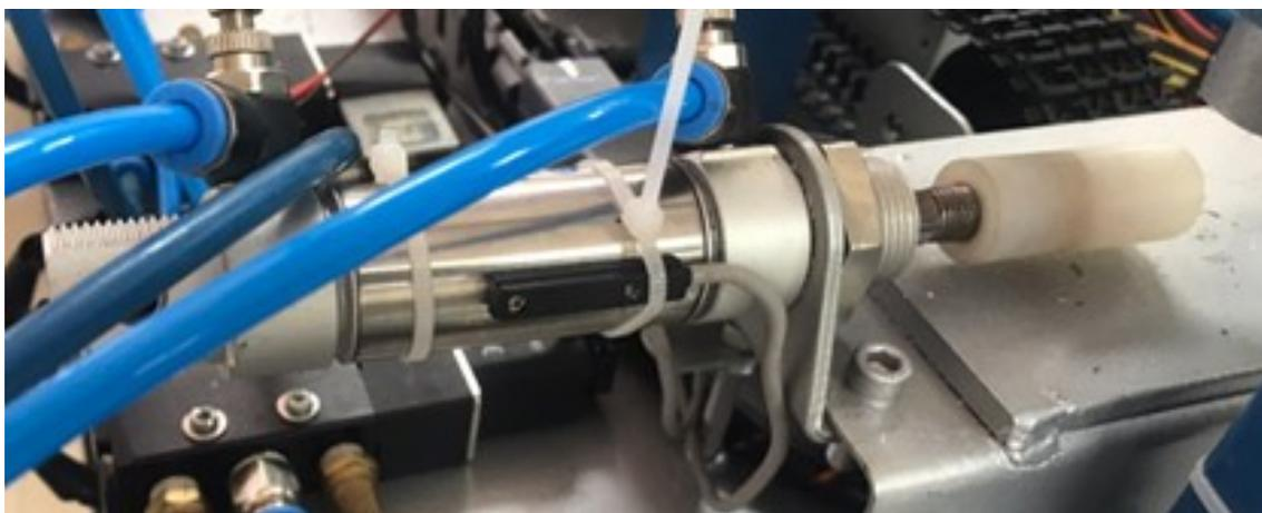
Figura 110: Cilindro doble efecto redondo[Autor Propio].
