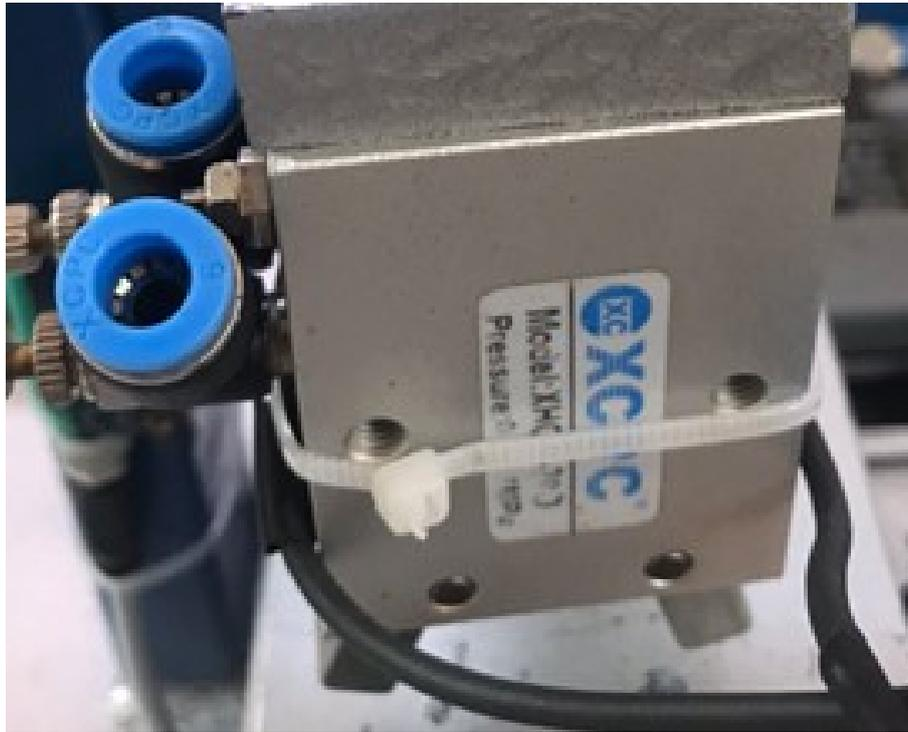
Figura 111: Pinza neumatica Angular [Autor Propio].
