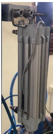
Figura 109: Cilindro doble efecto 2 [Autor Propio].
