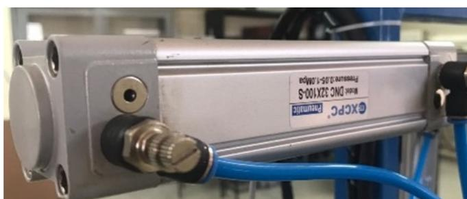
Figura 108: Cilindro doble efecto 1 [Autor Propio].
