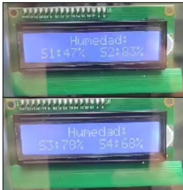
Figura 64. Lectura de los Sensores de Humedad
