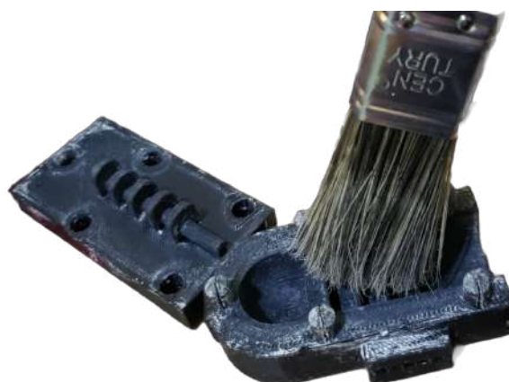
Figura 52: Aplicación Cera Desmoldante. Fuente: Quimiz D, Sierra X
