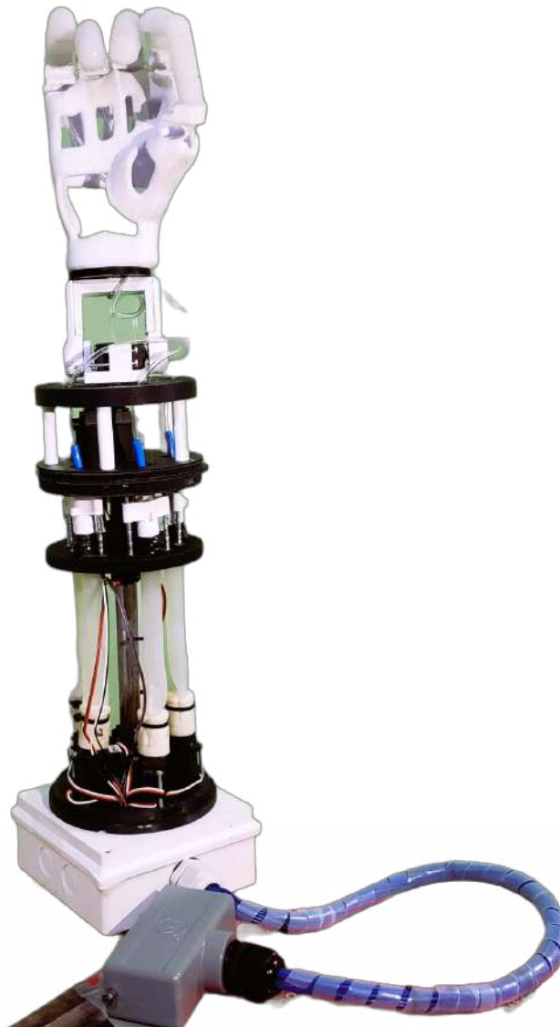
Figura 72: Diseño Final de Prototipo de Mano Robótica con Actuadores Suaves. Fuente: Quimiz D, Sierra X
