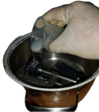
Figura 53: Aplicación de Ecoflex 00-10. Fuente: Quimiz D, Sierra X
