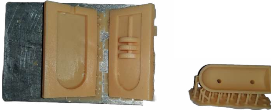
Figura 21: Proceso de Impresión de Molde de Dedo Pulgar. Fuente: Quimiz D, Sierra X
