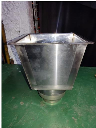
Figura 87. Primer prototipo de tolva de altura, por A. Ochoa y X. López, 2023.
