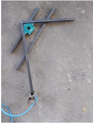
Figura 106. Contrucción de base soldandolas con electrodos, por A. Ochoa y X. López, 2023.
