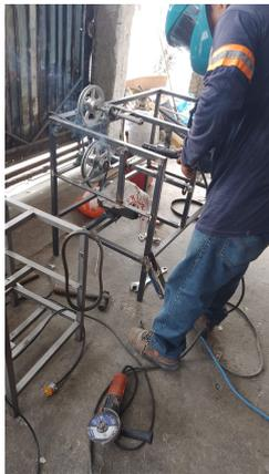
Figura 108. Contrucción de base soldandolas con electrodos, por A. Ochoa y X. López, 2023.
