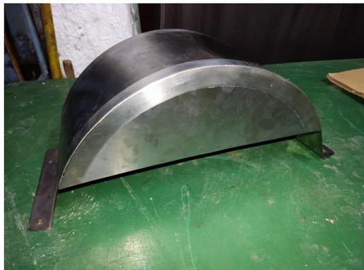
Figura 88. Cubierta o proteccion de poleas, por A. Ochoa y X. López, 2023.
