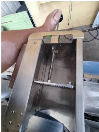
Figura 98. Palanca con resorte para empuje de los alimentos hacia las aspas de corte, por A. Ochoa y X. López, 2023.
