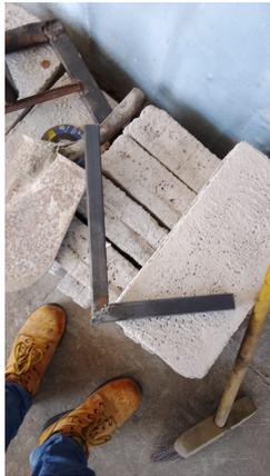
Figura 107. Contrucción de base soldandolas con electrodos, por A. Ochoa y X. López, 2023.
