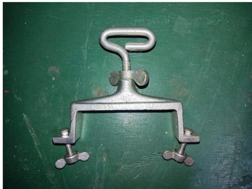
Figura 86. Soporte de montaje con tornillo de fijación, por A. Ochoa y X. López, 2023.
