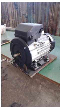
Figura 93. Motor trifásico usado para la molienda, por A. Ochoa y X. López, 2023.
