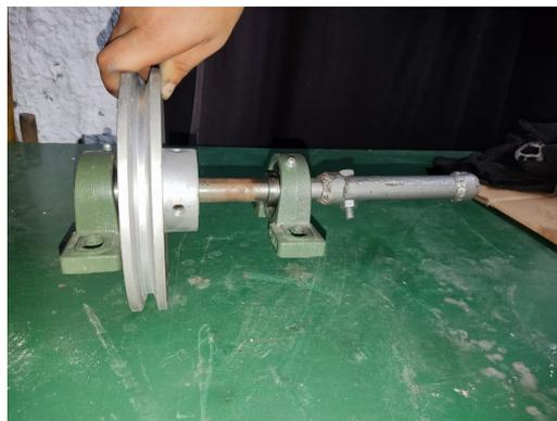
Figura 95. Polea superior que conecta con el cuerpo de la moledora, por A. Ochoa y X. López, 2023.
