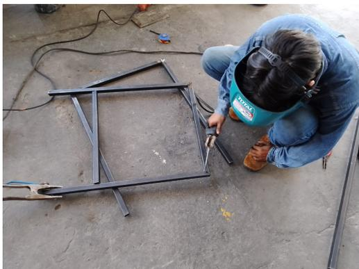
Figura 105. Contrucción de base soldandolas con electrodos, por A. Ochoa y X. López, 2023.
