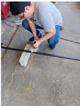
Figura 104. Corte de barras para la fabricación de la base, por A. Ochoa y X. López, 2023.
