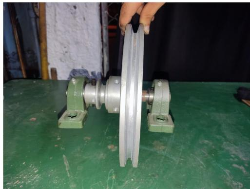
Figura 96. Poleas de en medio que conecta con la polea superior y la polea inferior, por A. Ochoa y X. López, 2023.
