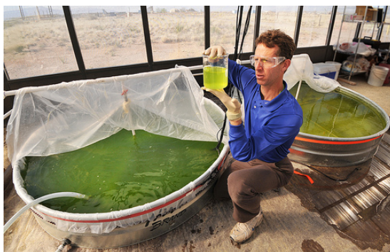
Figura 5: Tratamiento de aguas residuales con microalgas.
