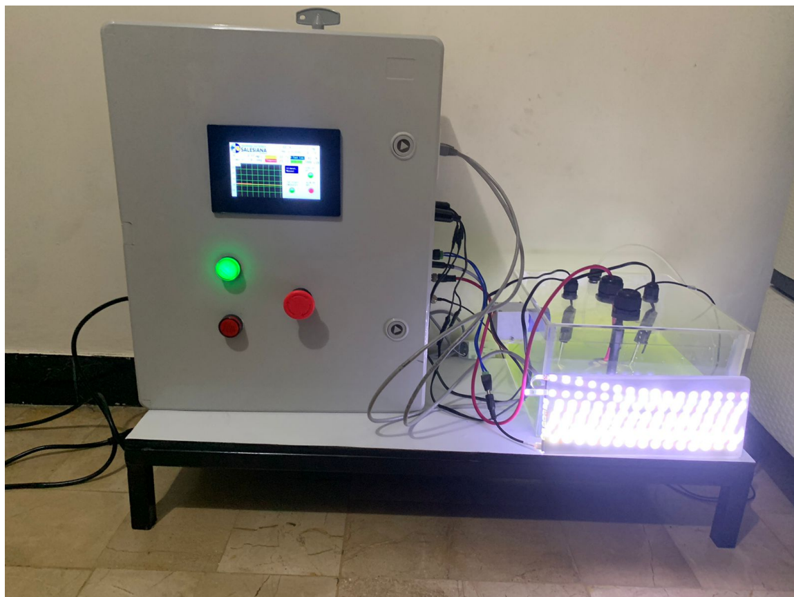
Figura 89: Funcionamiento del prototipo automático en el proceso de cultivo de microalgas
