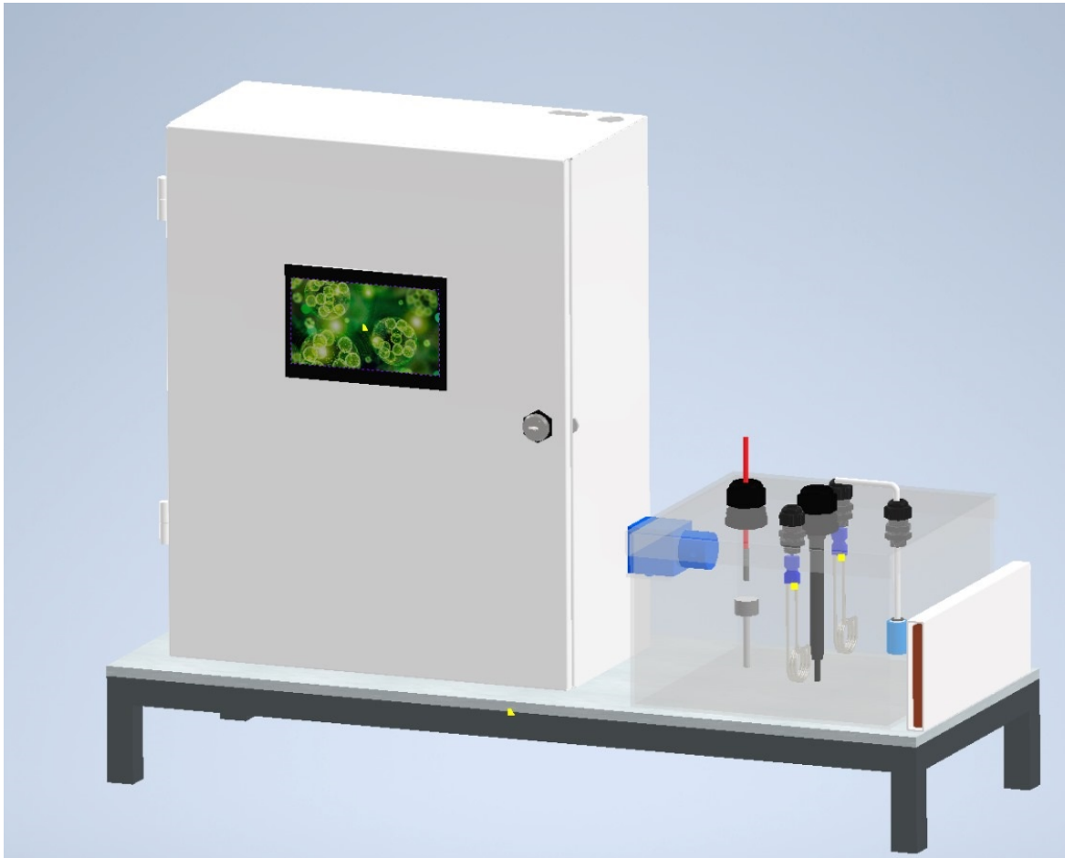
Figura 54: Diseño del recipiente de microalgas con el dispensador automático, sensores y actuadores
