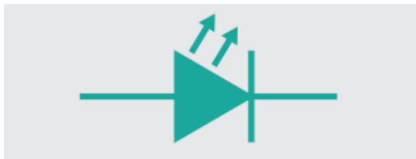
Figura 17: Símbolo eléctrico del LED Fuente: Energreencol (2010)
