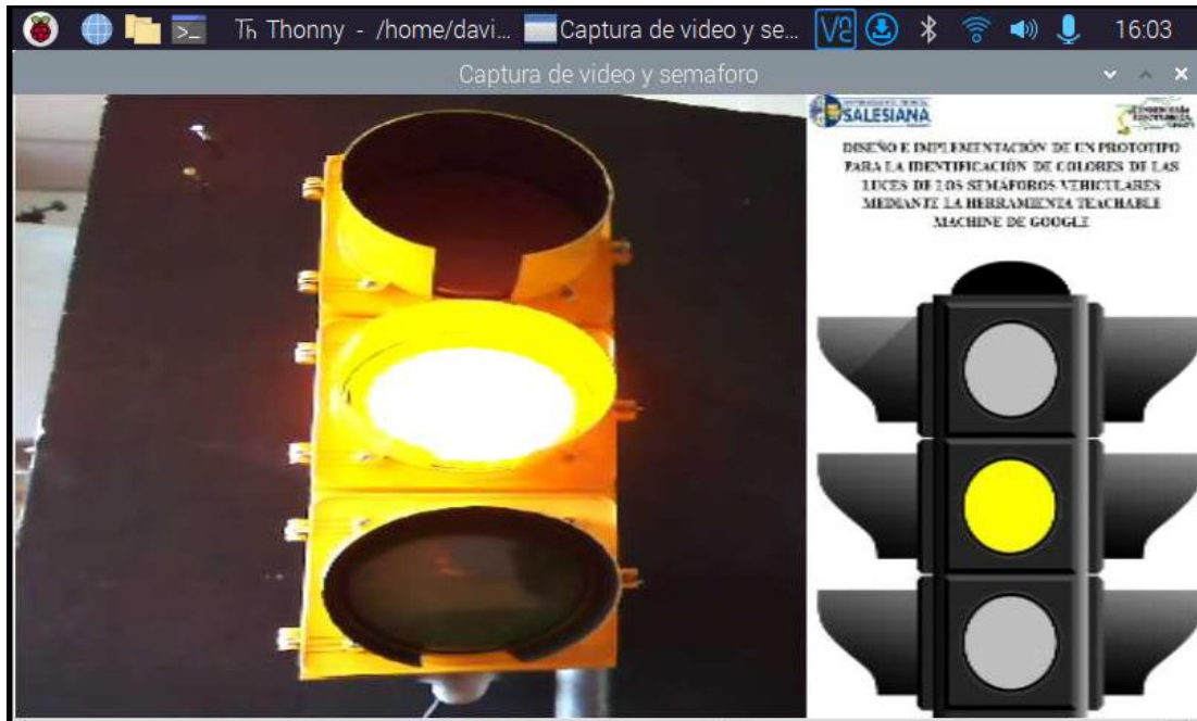
Figura 52: Predicción mediante raspberry usando modelo Keras para color amarillo con luminosidad normal
