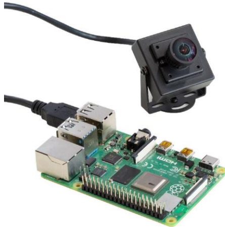
Figura 13: Conexiones en placa mediante USB para Cámara (piHUT, 2021)
