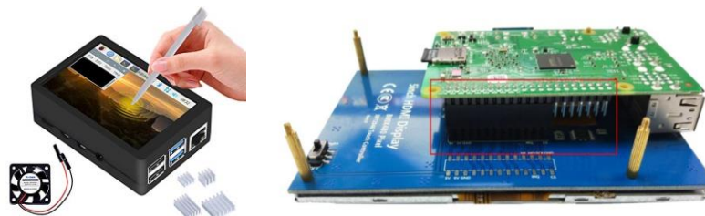
Figura 23: Conexiones de pantalla tft con zócalo en placa (ArduCAM, 2022)
