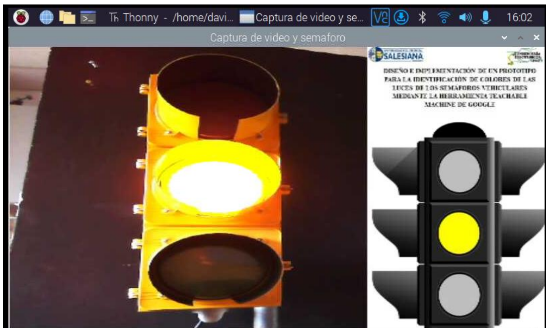
Figura 49: Predicción mediante raspberry usando modelo Keras para color amarillo con luminosidad reducida
