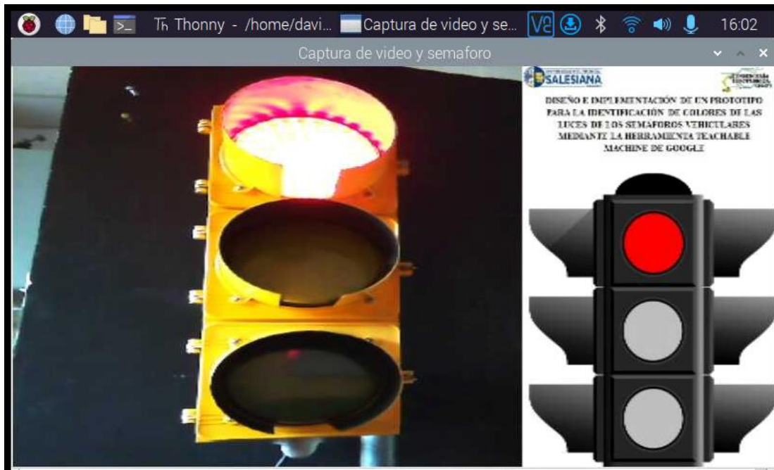
Figura 48: Predicción mediante raspberry usando modelo Keras para color rojo con luminosidad reducida
