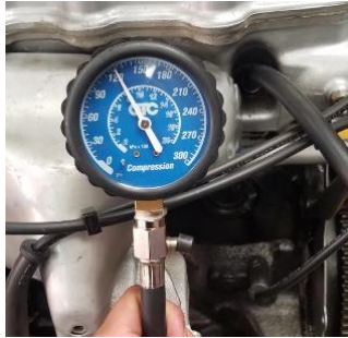
Figura 2-15 Medida de compresión cilindro 4
