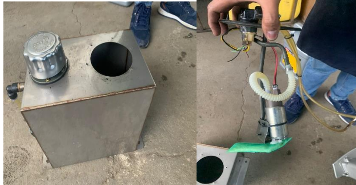
Ilustración 2.33: Tanque y bomba de combustible con sus conexiones
