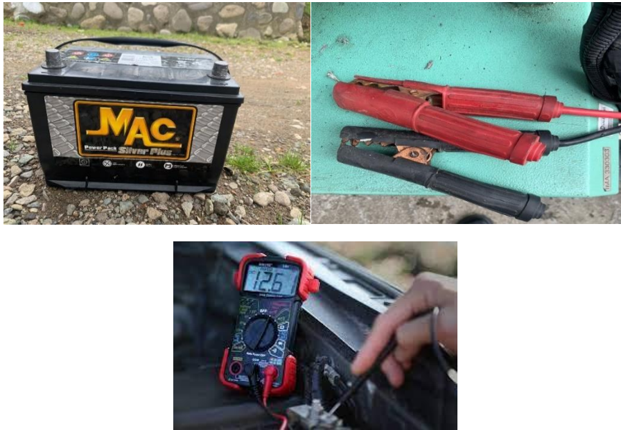
Ilustración 2.8: Batería y su respectiva verificación con el multímetro
