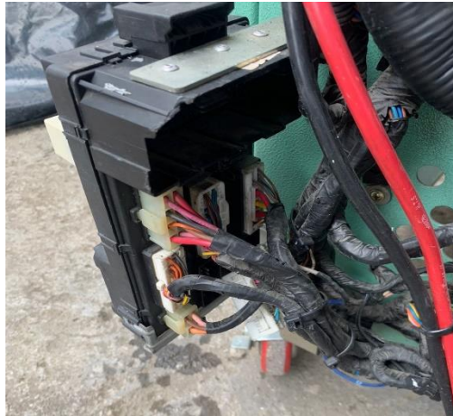
Ilustración 2.37: Conexiones con cobertura de protección
