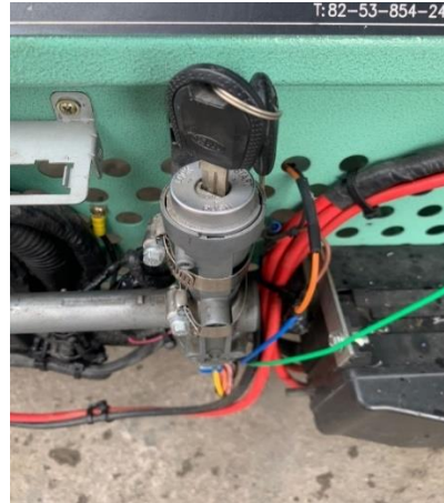
Ilustración 2.18: Switch de encendido
