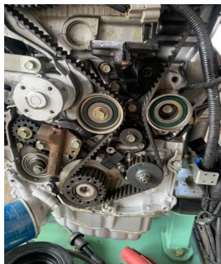
Ilustración 2.40: Puesta a punto de la banda de distribución.
