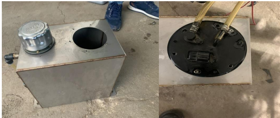
Ilustración 2.7: Depósito de gasolina y bomba de combustible sin conexiones
