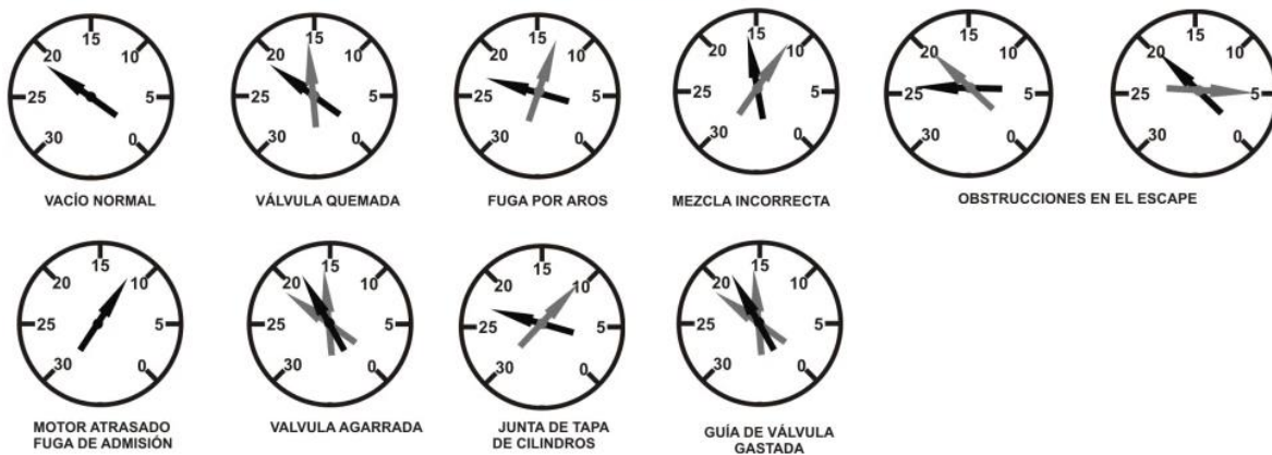
Figura 6. Diagnóstico por vacío con el motor a ralentí
