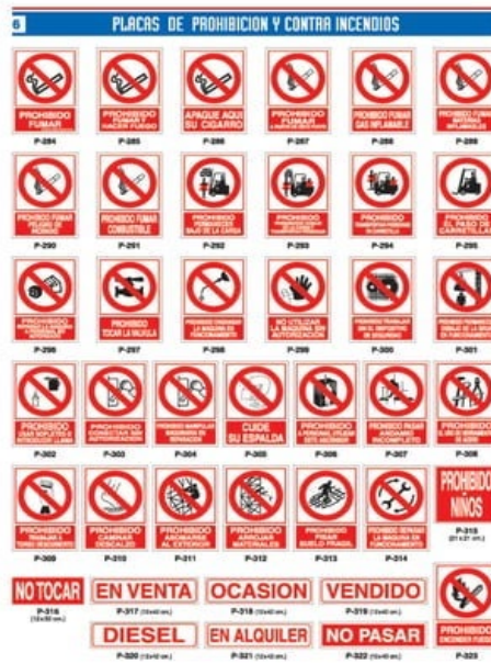
Figura 25. Placas de prohibición
