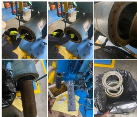
Figura 13. Cambio del Filtro Coalescente
