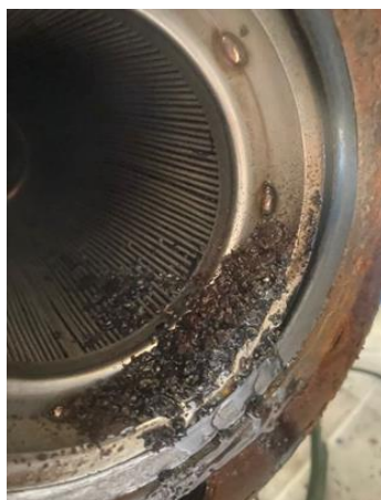
Figura 15. Limpieza de la malla de succión
