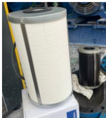
Figura 12. Filtro de malla nuevo
