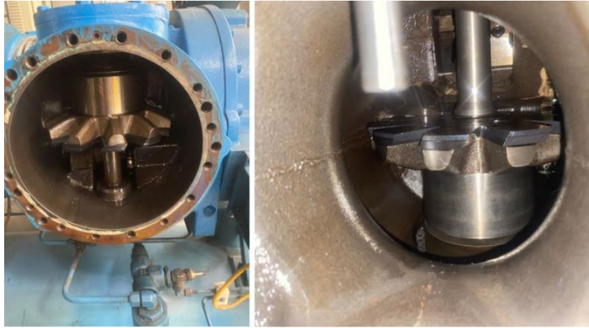
Figura 26. Cambio de rodamientos y estrellas de compresión
