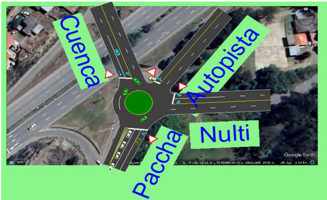
Ilustración 27 Simulación de tránsito para el año 2043 con aumentó de carriles del miércoles
