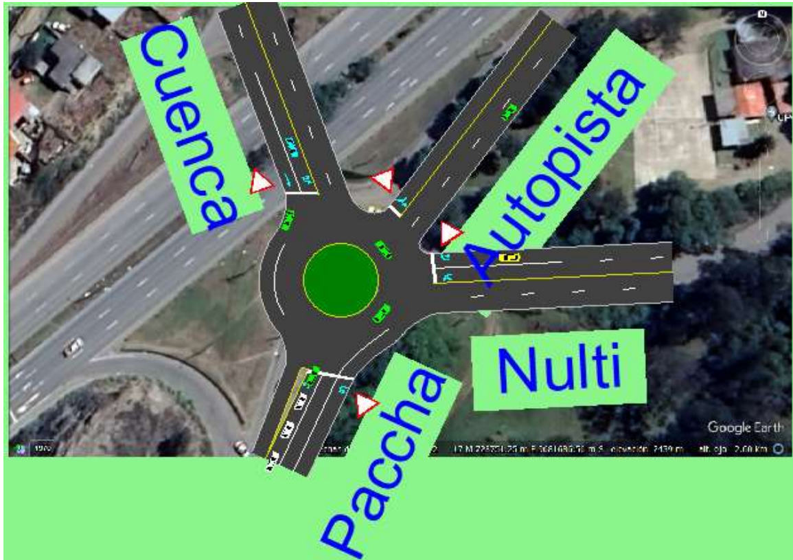
Ilustración 18 Simulación de tránsito para el año 2023 con aumentó de carriles del miércoles
