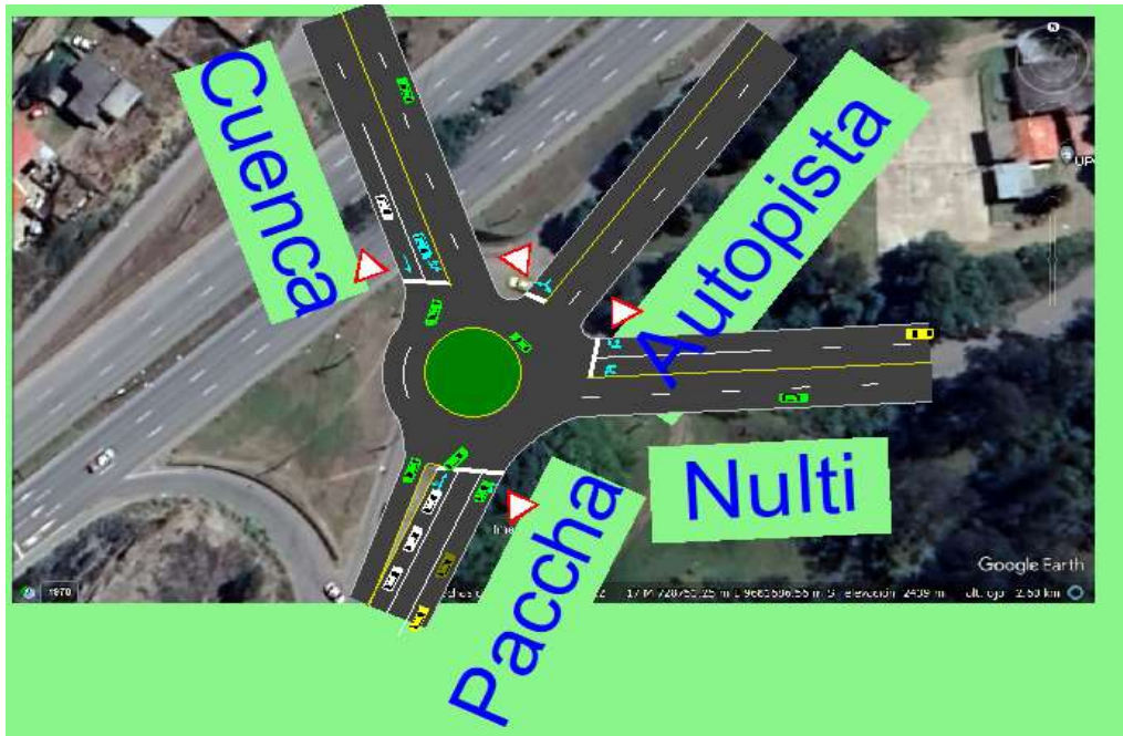
Ilustración 22 Simulación de tránsito para el año 2033 con aumentó de carriles del miércoles
