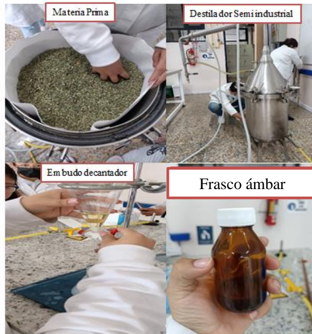
Figura 1 Método de destilación por arrastre de vapor en destilador semi industrial.
