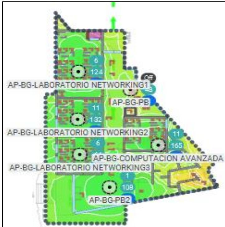
**Figura 5.6.** Zona de cobertura en la banda 2.4 GHz del bloque D Planta Baja
