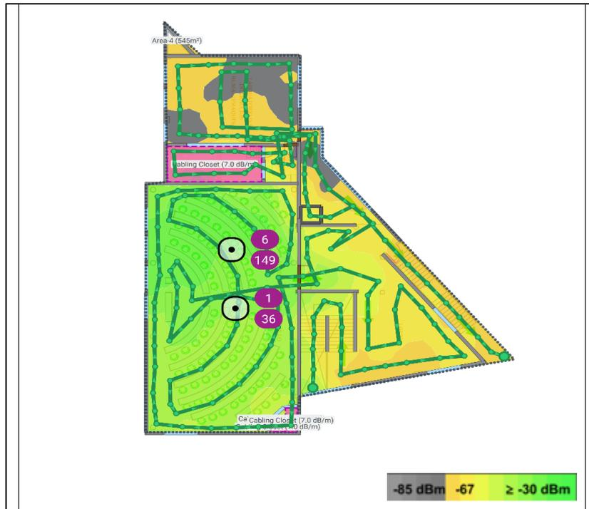
**Figura 3.11.** Zona de cobertura actual en la banda 5 GHz del bloque D Planta Alta
