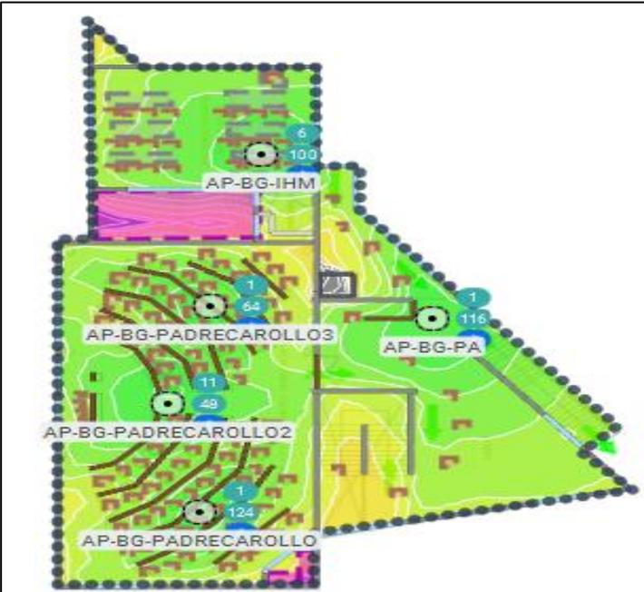
**Figura 5.9.** Zona de cobertura en la banda 5 GHz del bloque D Planta Alta
