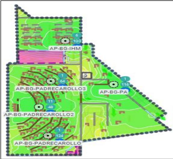
**Figura 5.8.** Zona de cobertura en la banda 2.4 GHz del bloque D Planta Alta
