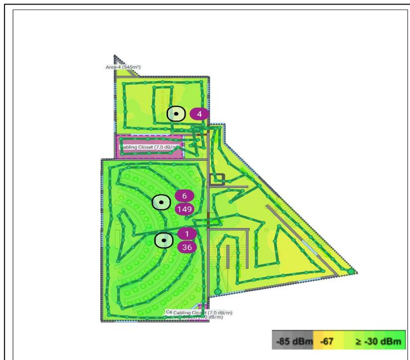
**Figura 3.10.** Zona de cobertura actual en la banda 2.4 GHz y número de APs del bloque D Planta Alta
