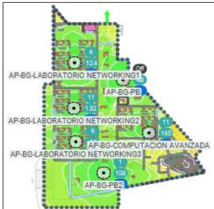
**Figura 5.7.** Zona de cobertura en la banda 5 GHz del bloque D Planta Baja
