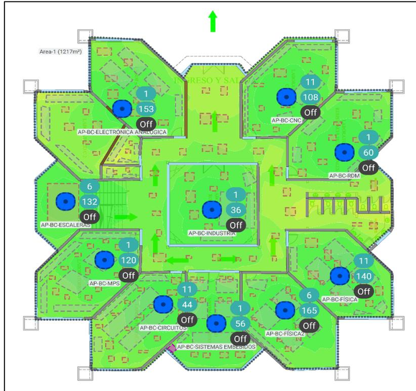
**Figura 5.2.** Zona de cobertura en la banda 2.4 GHz del bloque C planta baja
