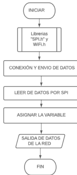
Figura 0.27 Diagrama de flujo para adquisición de datos de ESP32.
