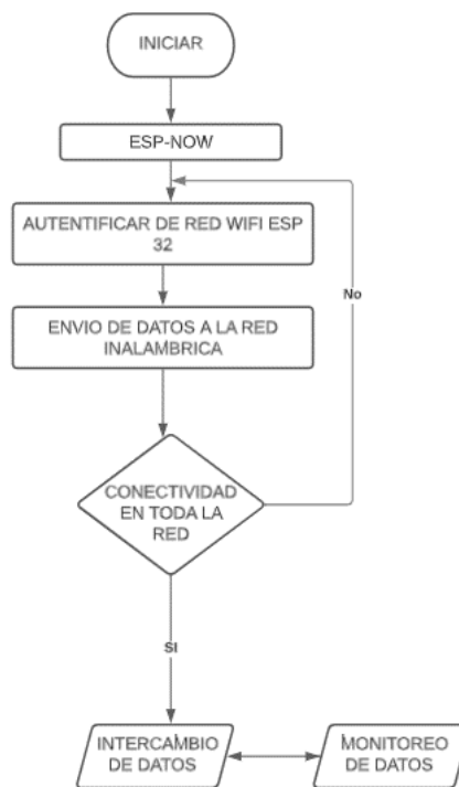
Figura 0.26 Diagrama de Flujo para monitoreo y envío de datos.
