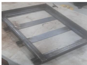
Figure 13. Base de rejilla de sumidero vial.
