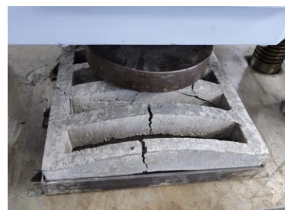
Figure 15. Rotura Total del prototipo de rejilla.
