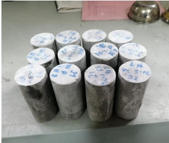
Figura 5. Cilindros de pasta de hormigón.
