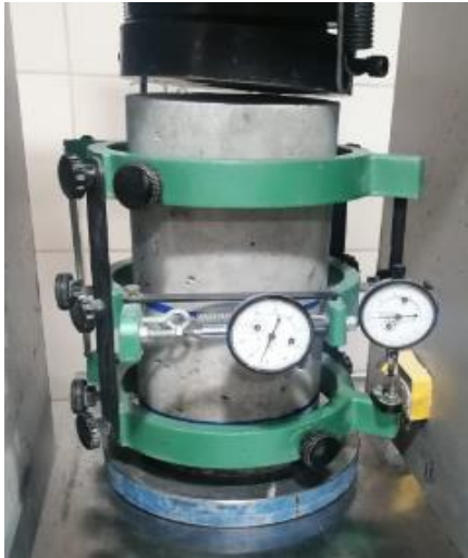
Figura 7. Método tradicional utilizando anillos de medición para calcular módulo de elasticidad.
