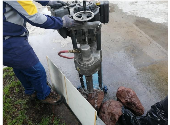
Figura 6. Extracción de Núcleos de Roca con la utilización de la máquina universal.
