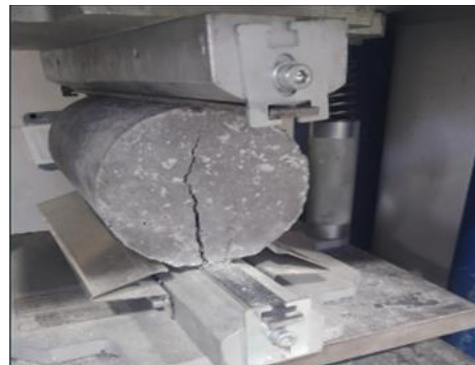
Figura. 10. Rotura a tracción 1.25% de fibras de caucho
