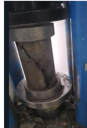
Figura. 7. Rotura a compresión.
