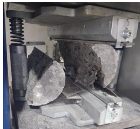
Figura. 11. Rotura a tracción de cilindro de hormigón
