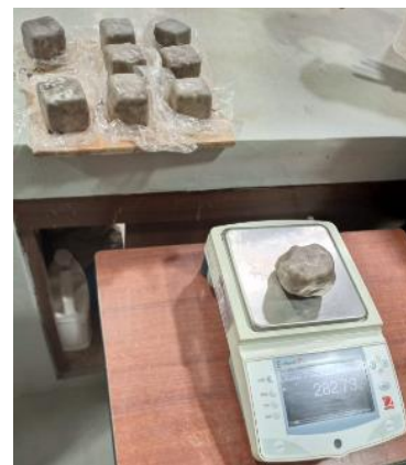
Figura 7. Ensayo de densidad natural "Muestras cubiertas con parafina"
