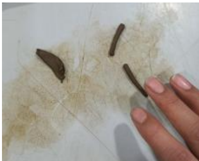
Figura 6. Ensayo de límite plástico "Rollo de muestra de 3mm"
