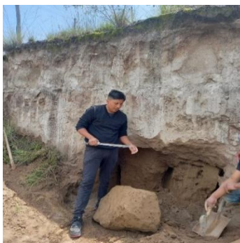
Figura 2. Extracción de muestras inalteradas.
