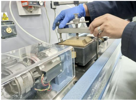
Figura 12. Ensayo de corte directo “Colocación de caja de corte en máquina de corte”
