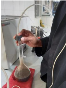
Figura 8. Ensayo de gravedad específica “Retiro de vacíos por medio mecánico”
