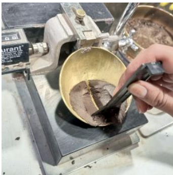
Figura 5. Ensayo de límite líquido "Muestra en surco de la cuchara de Casagrande".
