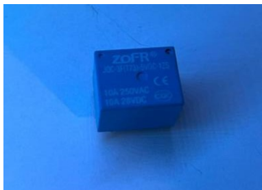
Figura 7. Relé Fuente: Autores
