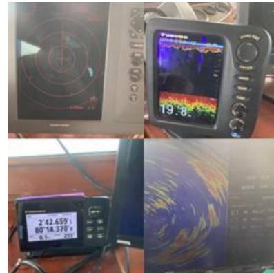
Figura 5 Equipos sala de mando (Sonar, GPS, sonda, radar, radio)
