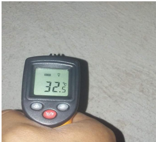
Figura A. 54 Toma de Medición temperatura de piso dentro del galpón [AUTOR]
