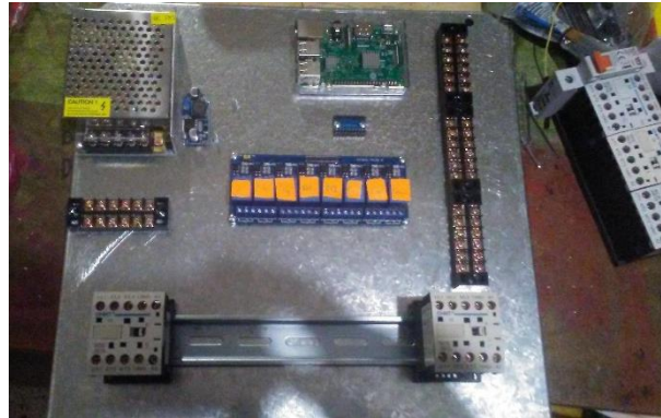
Figura A. 32 Proceso de Fabricación del tablero de control dimensionamiento de componentes[AUTOR].
