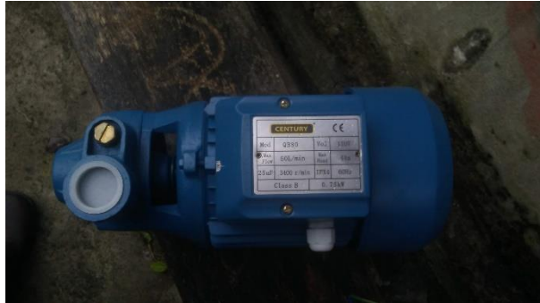
Figura A. 36. Bomba empleada para recirculación de agua [AUTOR].
