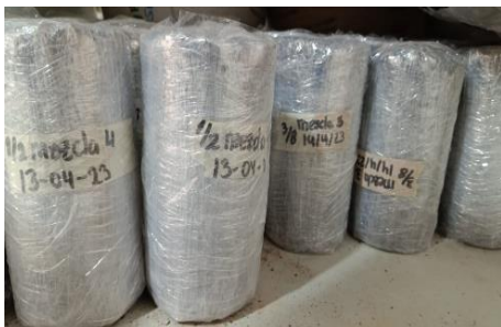
Figura 5. Curado de Cilindros para Medir la Permeabilidad
