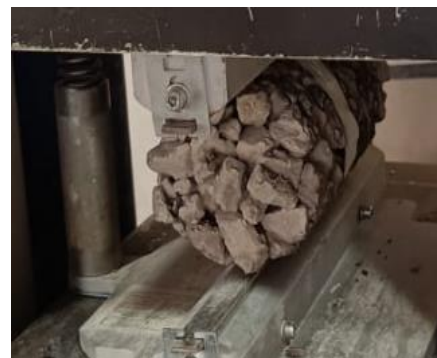
Figura 7. Ensayo de Tracción Indirecta
