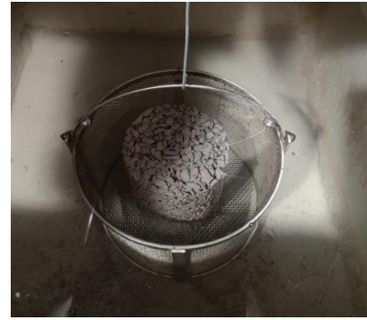
Figura 3. Determinación de la densidad y contenido de aire en el concreto permeable endurecido, para las gradaciones, N°56, N°57, N°6 y N°7
