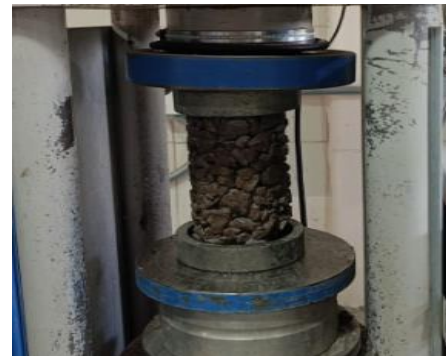
Figura 6. Ensayo a Compresión (Hormigón Permeable 10 x 20 cm)
