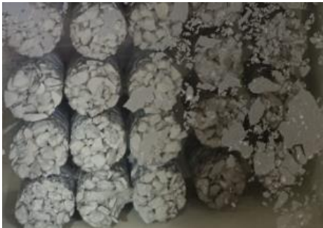
Figura 4. Curado de las Probetas de Hormigón Permeable en Piscina con Cal
