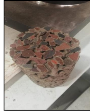
Figura 7. Ensayo de Permeabilidad.
