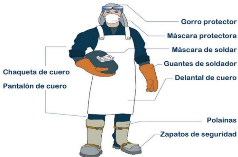
Fuente: Soldadura aplicada a mecanismos automotrices
