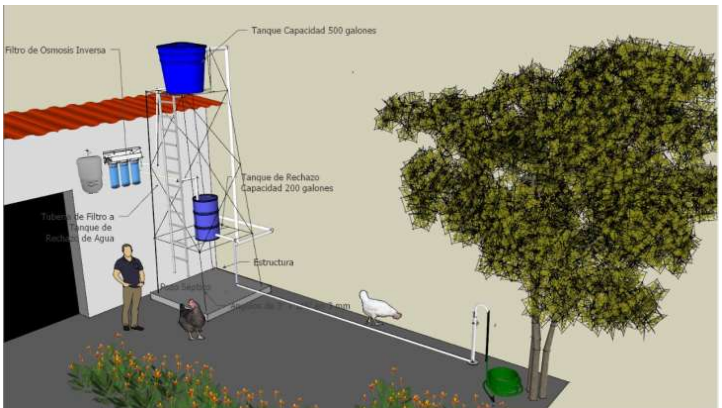
Figura 8 Ubicación y diseño del filtro osmosis inversa 5 etapas.
