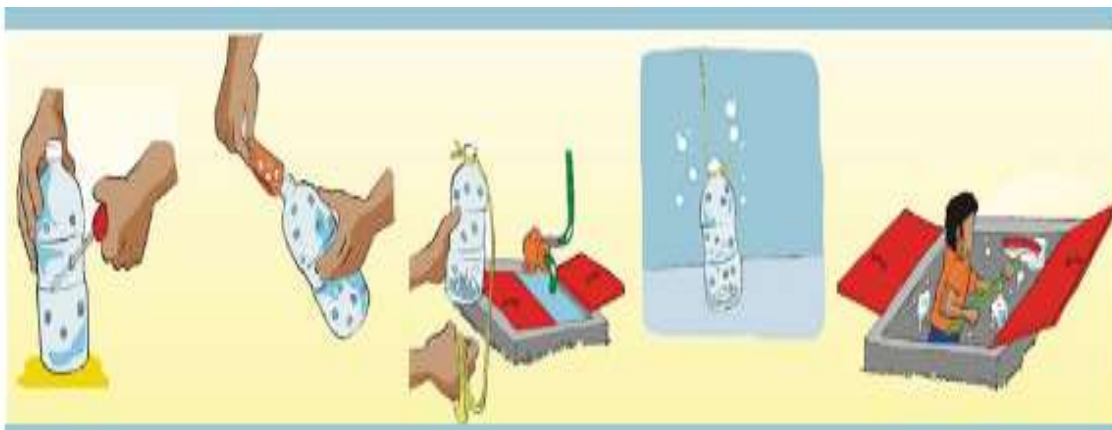
Figura 4 Pasos para desinfección de cisternas
