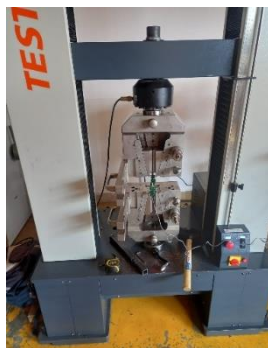
Figura 4. Máquina de Ensayo a tracción del laboratorio de la Universidad Politécnica Salesiana.
