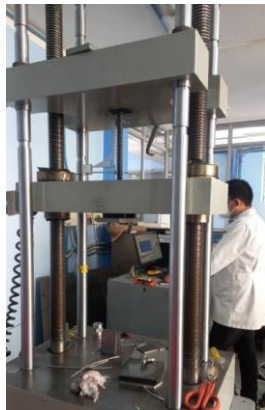
Figura 3. Máquina de Ensayo a tracción del laboratorio del INEN.
