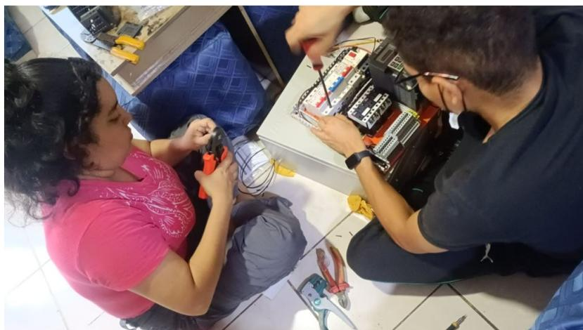
Figura 61: Montaje del tablero eléctrico del prototipo de máquina secadora para cacao tipo rotatoria. [Ilustración 61], por Naranjo, J. y Vera, D., 2023.
