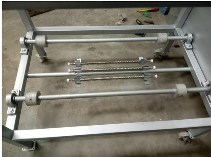
Figura 54: Ejes con resbalones y resistencias eléctricas del prototipo de máquina secadora para cacao tipo rotatoria. [Ilustración 54], por Naranjo, J. y Vera, D., 2023.
