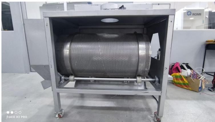
Figura 57: Montaje del bomo mallado del prototipo de máquina secadora para cacao tipo rotatoria. [Ilustración 57], por Naranjo, J. y Vera, D., 2023.
