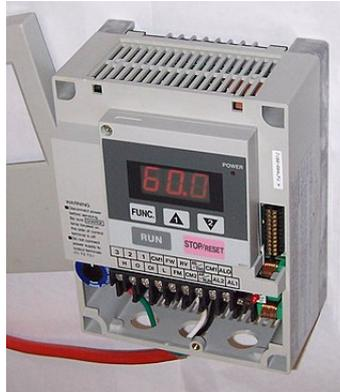
Figura 17: Variador de Frecuencia. [Ilustración 17], por Soler Paleu, 2020.
