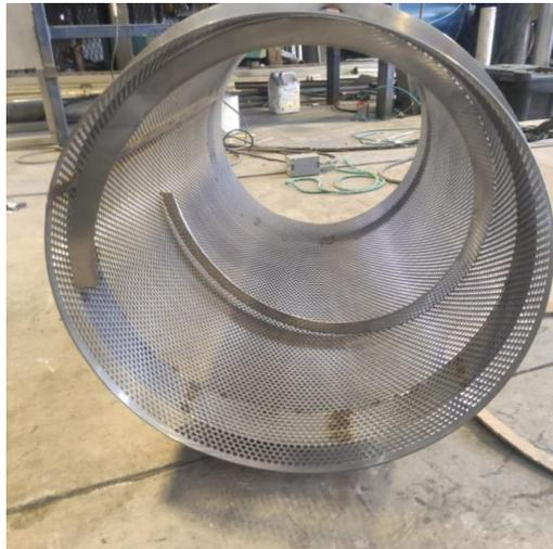
Figura 51: Bombo mallado de Acero Inoxidable AISI 304 con media lunas soldadas. [Ilustración 51], por Naranjo, J. y Vera, D., 2023.
