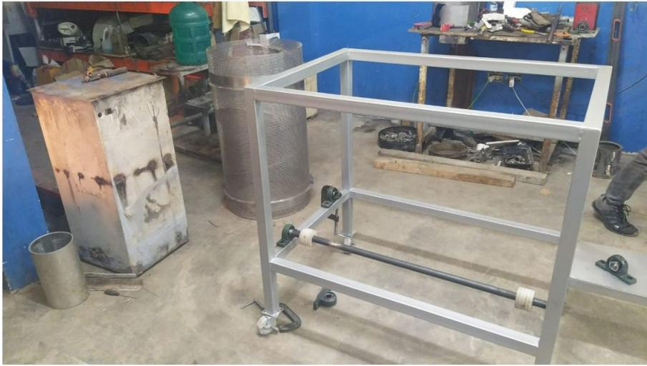
Figura 53: Estructura del prototipo de máquina secadora para cacao tipo rotatoria. [Ilustración 53], por Naranjo, J. y Vera, D., 2023.
