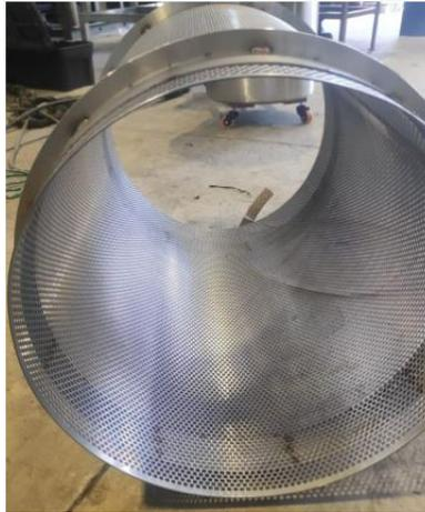
Figura 50: Bombo mallado de Acero Inoxidable AISI 304 sin media lunas soldadas. [Ilustración 50], por Naranjo, J. y Vera, D., 2023.
