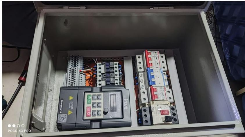
Figura 62: Diseño del tablero eléctrico del prototipo de máquina secadora para cacao tipo rotatoria. [Ilustración 62], por Naranjo, J. y Vera, D., 2023.
