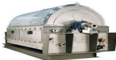
Figura 10: Secador de Tambor. [Ilustración 10], por Peñaherrera, 2021.
