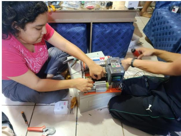
Figura 60: Montaje del tablero eléctrico del prototipo de máquina secadora para cacao tipo rotatoria. [Ilustración 60], por Naranjo, J. y Vera, D., 2023.
