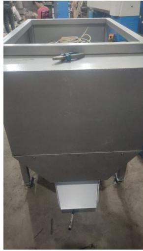
Figura 56: Salida del producto del prototipo de máquina secadora para cacao tipo rotatoria. [Ilustración 56], por Naranjo, J. y Vera, D., 2023.
