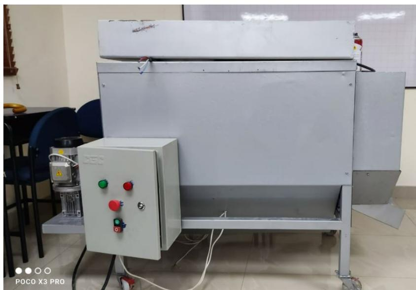
Figura 58: Prototipo de máquina secadora para cacao tipo rotatoria. [Ilustración 58], por Naranjo, J. y Vera, D., 2023.
