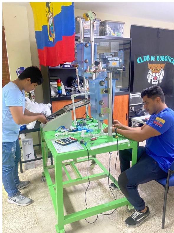
Figura 17. Desconectando y Desmontando el cableado y tablero
