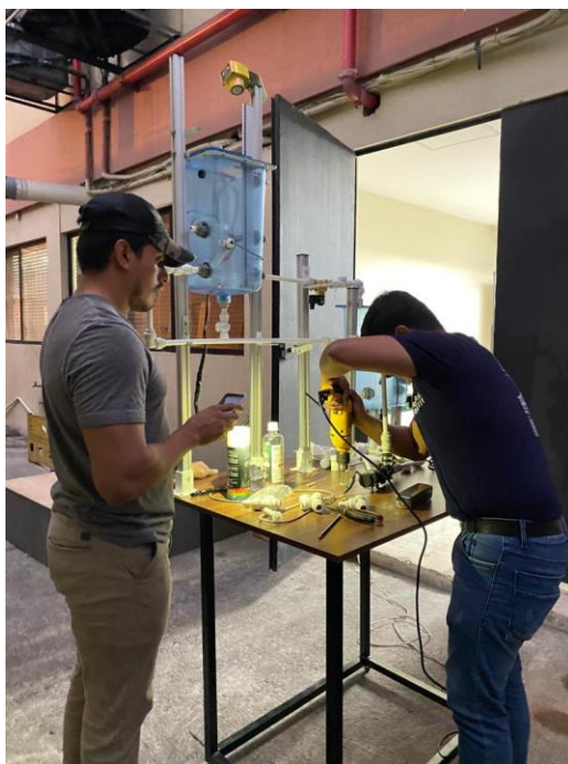
Figura 23. Realizando agujero para la bomba sobre la mesa
