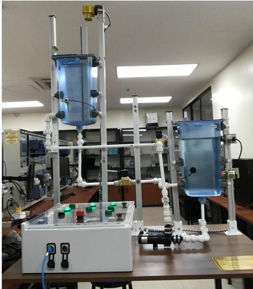
Figura 30. Planta instalada después pruebas y cambios
