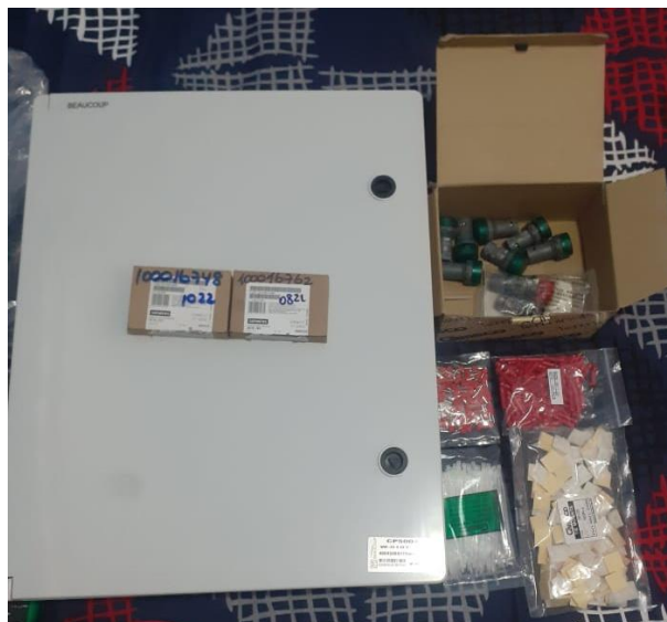
Figura 32. Tablero de control, luces piloto, punteras, amarras y pegatina.
