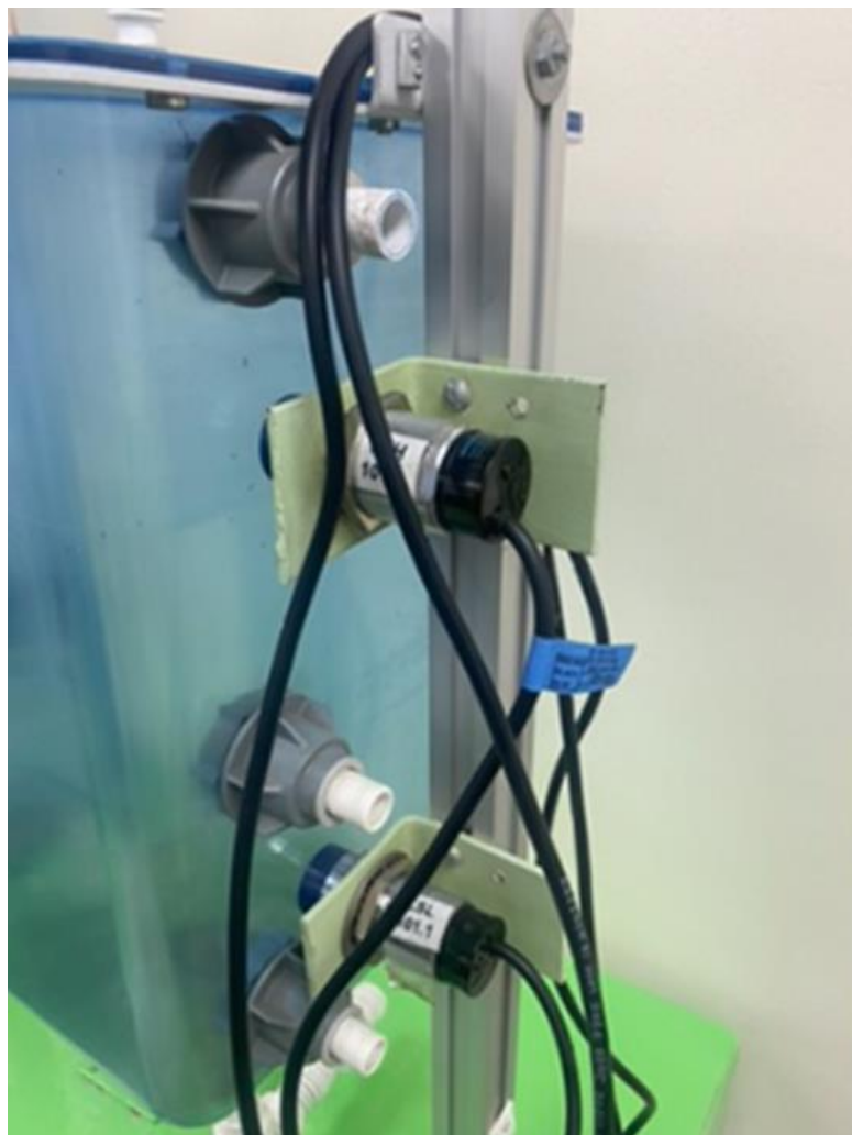
Figura 12. Solenoide averiado antes de desmantelar
