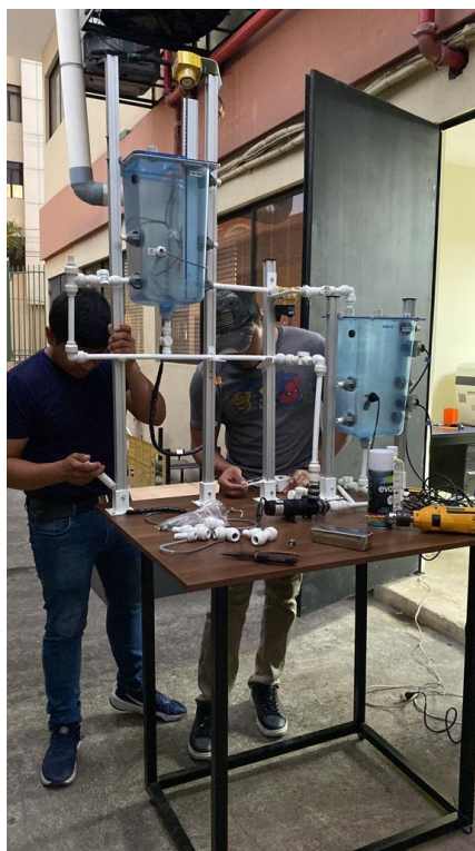
Figura 24. Inyección de pega tanque entre base y pilar
