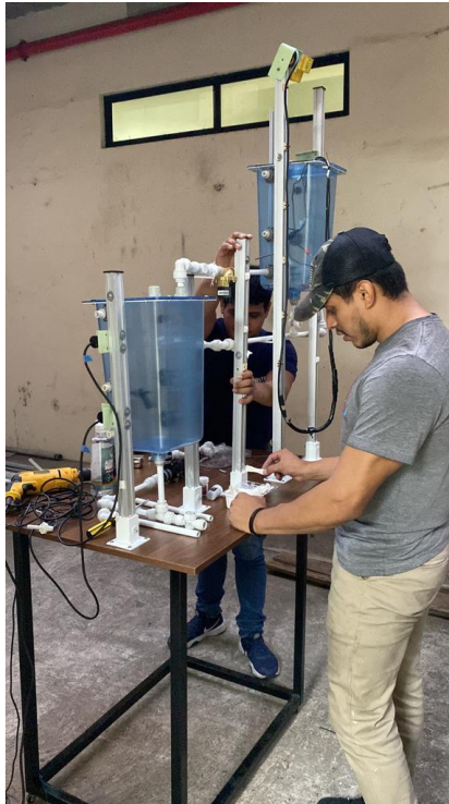
Figura 25. Fijación de pilar después de insertar adhesivo pega tanque
