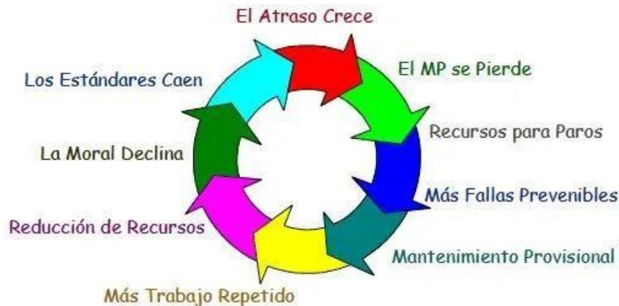
Figura 13. Ciclo Vicioso del Mantenimiento Reactivo
