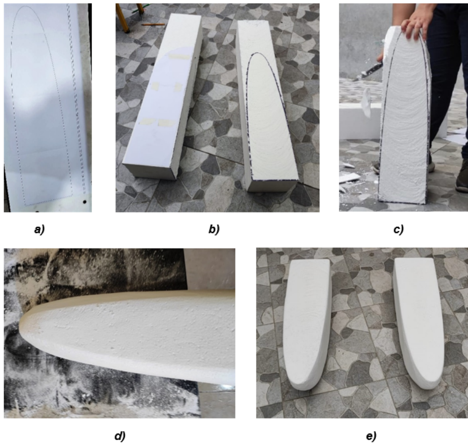
Figura 36. Proceso de moldeo de los cascos usando EPS, por A. Sánchez y L. Suárez
