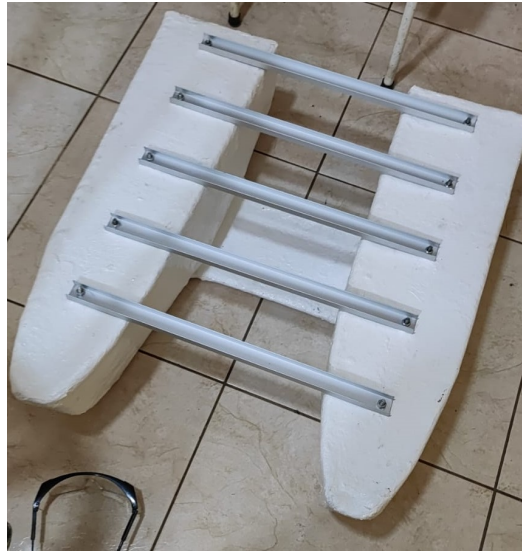
Figura 42. Ensamble entre travesaños y casco, por A. Sánchez y L. Suárez
