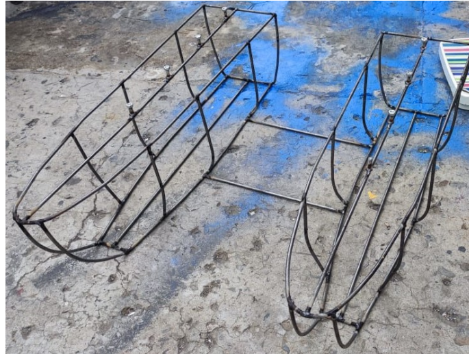
Figura 39. Unión de la estructura interna de los 2 cascos, por A. Sánchez y L. Suárez
