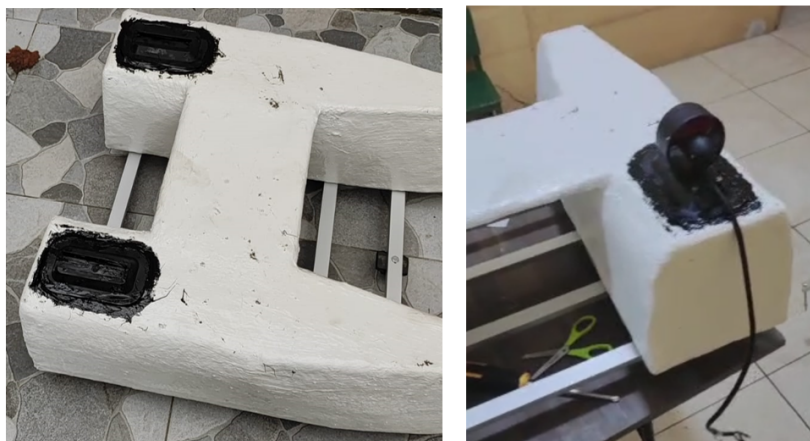
Figura 45. Ensamble entre propulsores y casco, por A. Sánchez y L. Suárez
