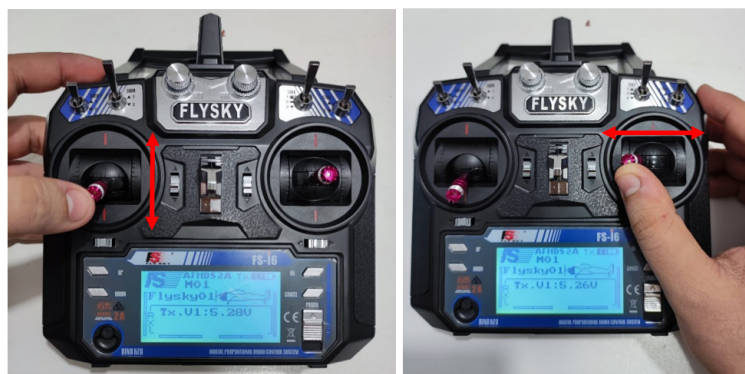
Figura 50. Movimientos que se pueden realizar con las 2 palancas principales, por A. Sánchez y L. Suárez
