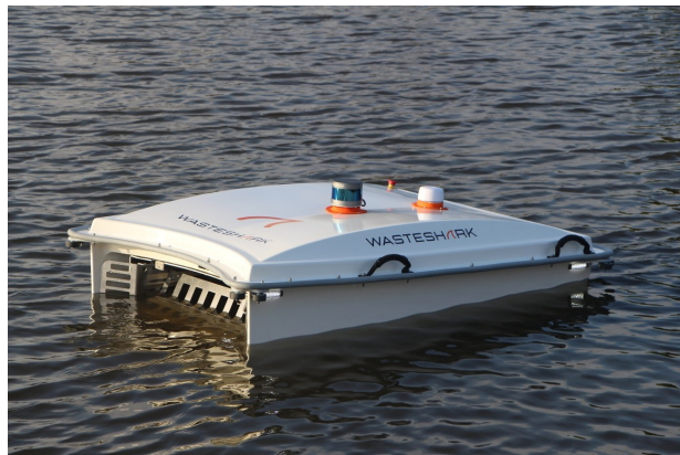
Figura 6. Vehículo de superficie no tripulado Wasteshark [28]
