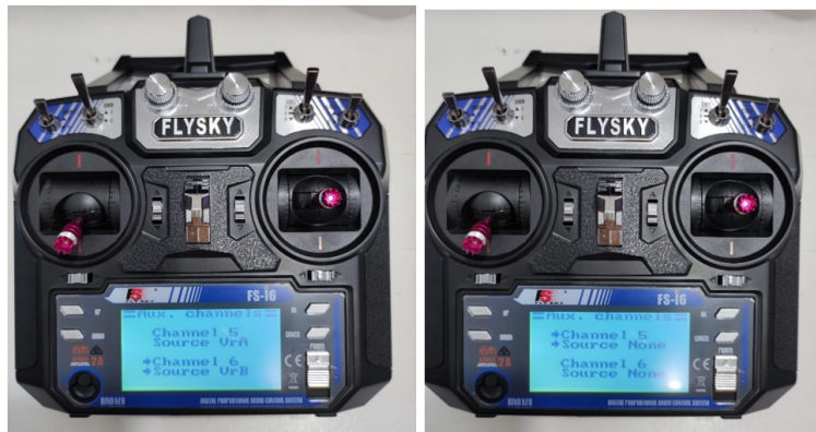
Figura 51. Desactivación de los canales auxiliares, por A. Sánchez y L. Suárez
