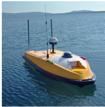
Figura 3. Vehículo de superficie no tripulado SAL40 [9]
