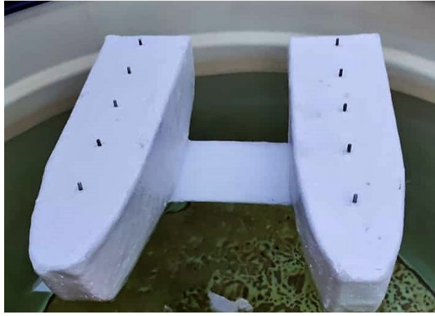
Figura 40. Casco con fibra de vidrio, por A. Sánchez y L. Suárez
