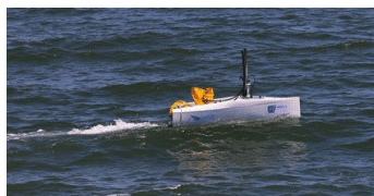
Figura 4. Vehículo de superficie no tripulado UCAP [22]
