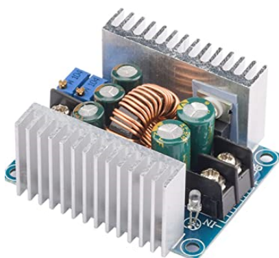
Figura 29. Regulador reductor de voltaje “DIYMORE 20 A 300 W” [4]
