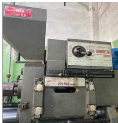
Figura 18. Tolva de la máquina inyectora Sandretto
