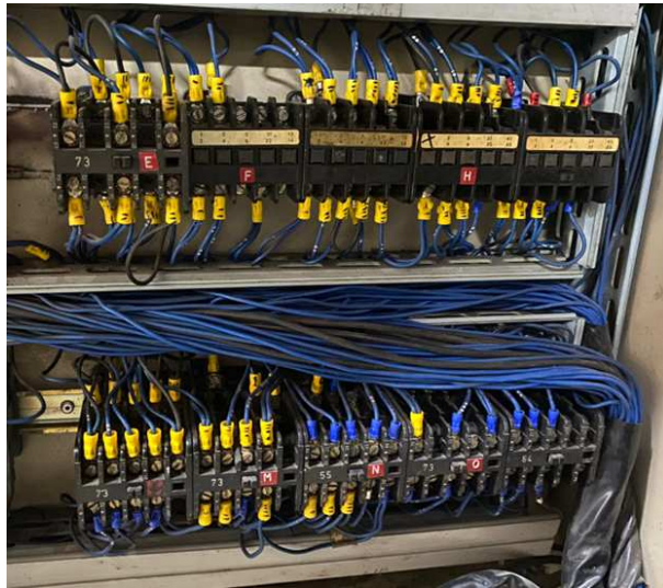
Figura 26. Contactores de la máquina inyectora Sandretto
