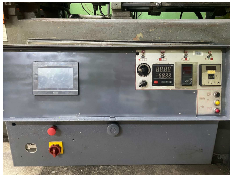
Figura 41. Nuevo panel con la inclusión del HMI
