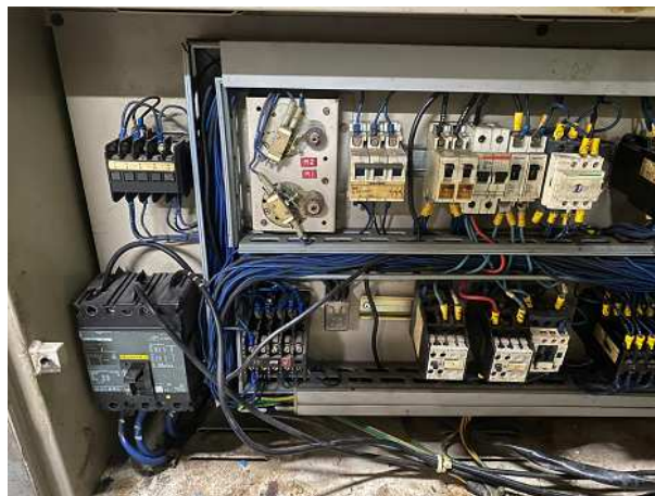
Figura 25. Fuente y breakers de la máquina inyectora Sandretto
