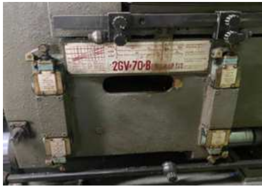
Figura 22. Pin de carrera de la máquina inyectora Sandretto
