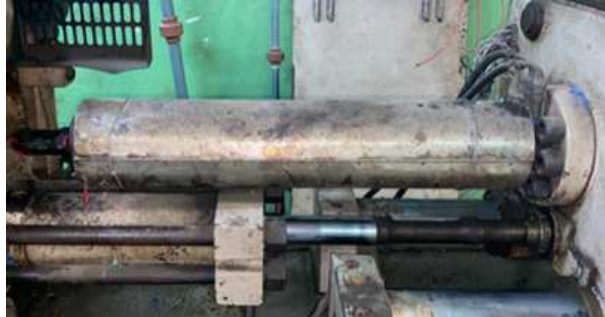
Figura 19. Tornillo sin fin de la máquina inyectora Sandretto
