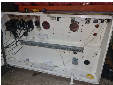
Figura 35. Pintado del nuevo tablero para colocación del HMI y pirómetros de la máquina
