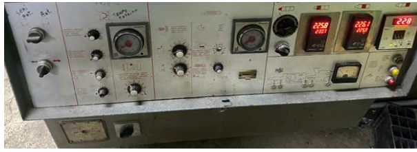
Figura 27. Panel de control de la máquina inyectora Sandretto
