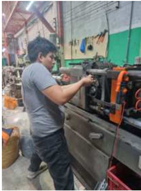
Figura 10. Proceso de desmonte de la caja de molde
