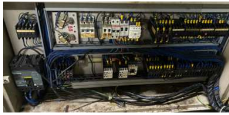
Figura 24. Panel de control de la máquina inyectora Sandretto
