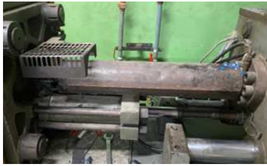
Figura 21. Cuerpo inyector y rejilla de la máquina inyectora Sandretto
