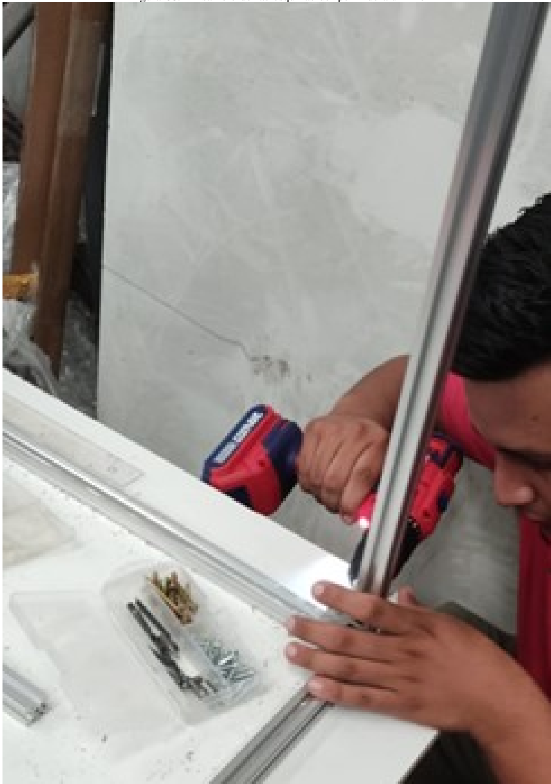
Figura 68. Ensamble de las esquinas del perfil de aluminio
