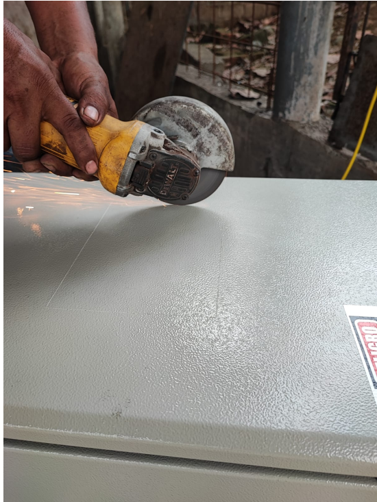
Figura 96. Corte para montar HMI [13]
