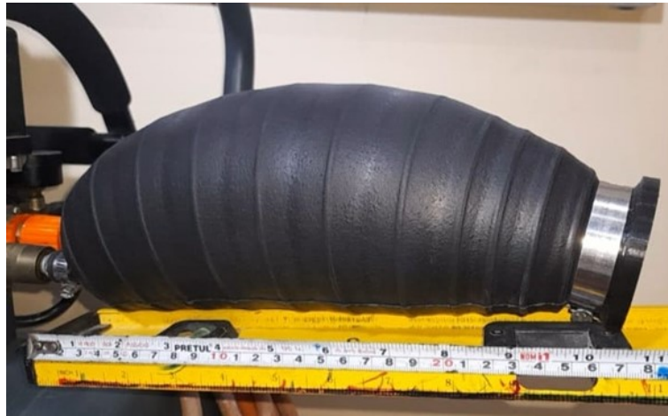
Figura 76. Actuador sometido a fuerzas de presión máxima establecidas en previos cálculos. Elaborado por los autores.
