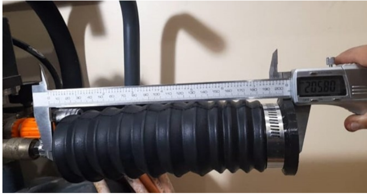
Figura 74. Actuador sometido a cargas de presión a su máxima deformación ante la ruptura. Elaborado por los autores.
