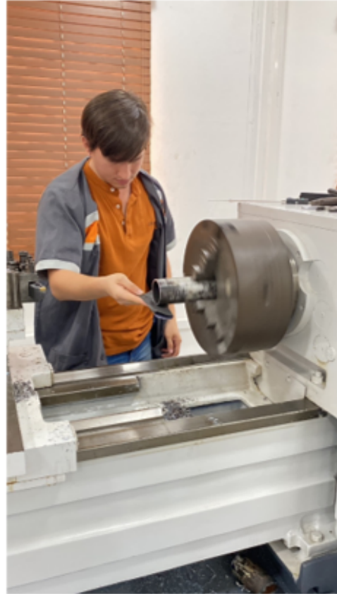
Figura 110. Mecanizado de rectificado de tubos para introducir rodamiento. Elaborado por autores.
