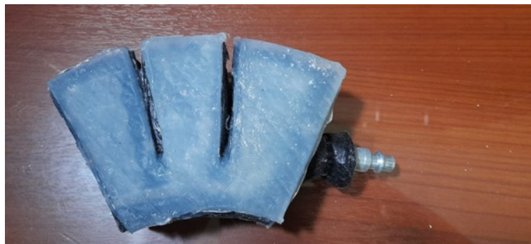
Figura 61. Primer prototipo realizado por método de litografía. Elaborado por autores.
