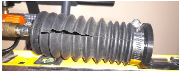
Figura 77. Ruptura del actuador blando por aplicación de fuerzas de presión máxima. Elaborado por los autores.
