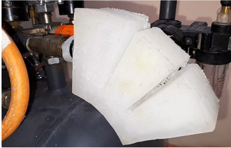
Figura 62. Ensayos de presión del prototipo de actuador blando. Elaborado por autores.
