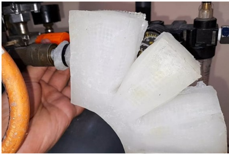
Figura 63. Aplicación de presión en actuador blando, observando deformaciones y grados de libertad. Elaborado por autores.
