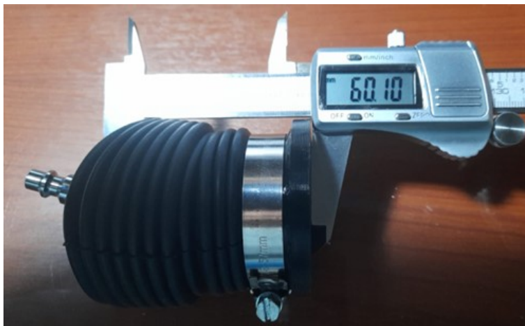
Figura 75. Actuador sometido a fuerzas de compresión reduciendo su tamaño un 75 %. Elaborado por los autores.
