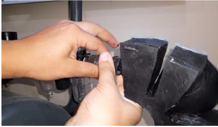
Figura 64. Ensayo destructivo del prime prototipo de actuador blando. Elaborado por autores.
