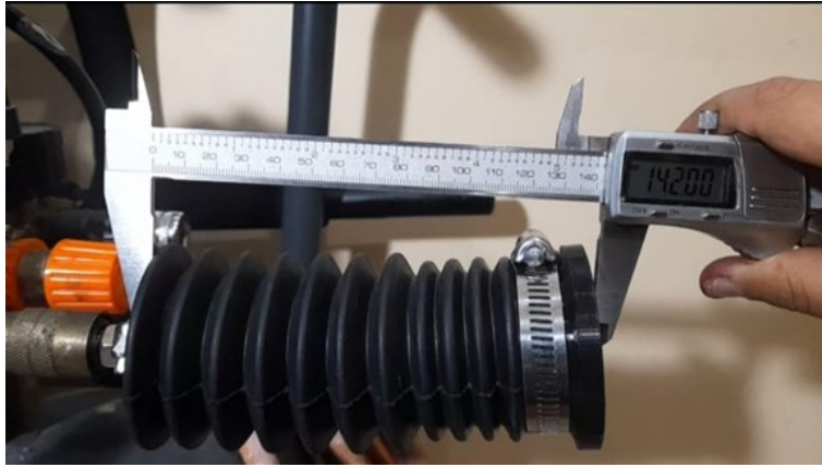
Figura 72. Actuador sometido a cargas de presión sin llegar a su máxima deformación. Elaborado por los autores.
