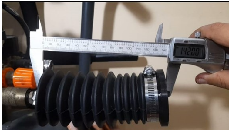
Figura 71. Actuador en estado inerte sin presión aplicada Elaborado por los autores.
