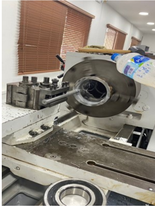
Figura 111. Mecanizado interno del tubo base de la estructura. Elaborado por autores.
