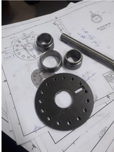
Figura 114. Comprobación de medidas de las piezas con sus respectivos planos. Elaborado por autores.
