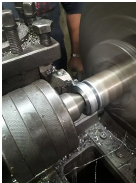
Figura 113. Uso del torno para rectificación de piezas. Elaborado por autores.
