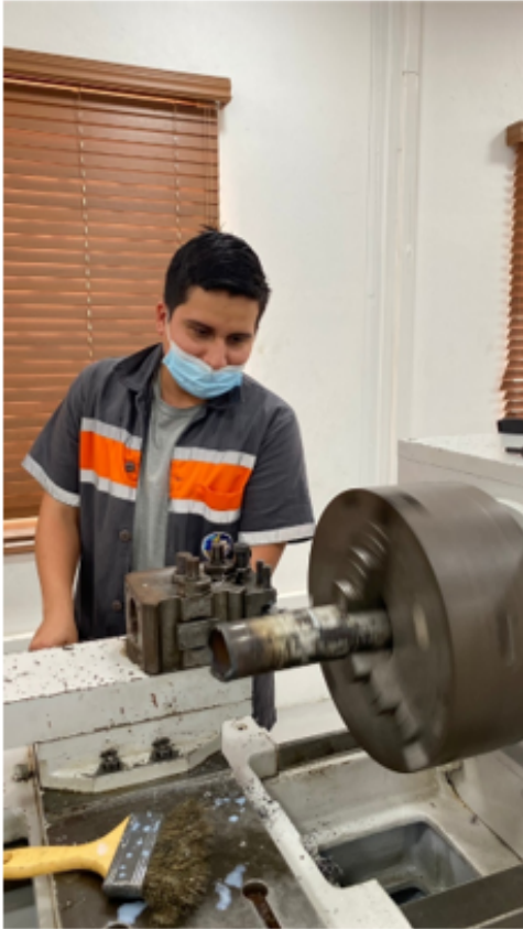
Figura 110. Mecanizado de rectificado de tubos para introducir rodamiento. Elaborado por autores.
