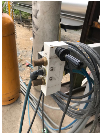
Figura 37. ELECTROVÁLVULA 5/3 DE ACCIONAMIENTO MANUAL PARA CONTROLAR EL CILINDRO NEUMÁTICO
