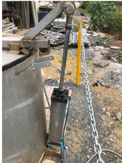
Figura 36. CILINDRO NEUMÁTICO UTILIZADO PARA CIERRE Y APERTURA DEL HORNO
