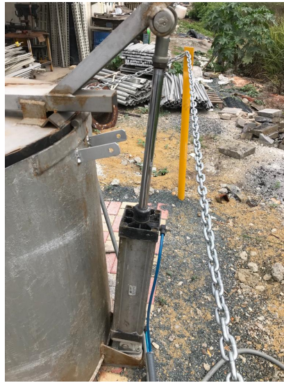
Figura 31. CILINDRO NEUMÁTICO ACOPLADO A TAPA DE HORNO
