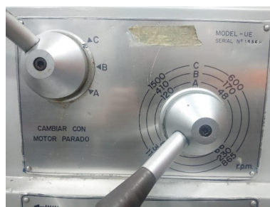
Figura 29. Caja de velocidades de la fresadora.
