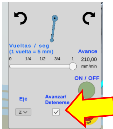
Figura 6. Iniciar avance del banco de trabajo
