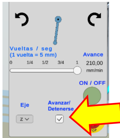
Figura 6. Iniciar avance del banco de trabajo
