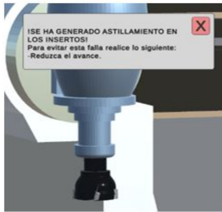
Figura 44. Alerta por fallo de astillamiento.
