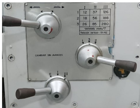
Figura 33. Caja de cambios para avances automáticos.
