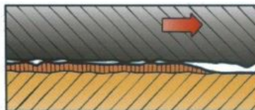
Figura 20. Desgaste por adhesión según Antonio Guarnido Barrera.
