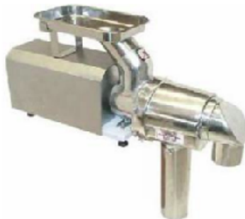
Figura 3: Despulpadora de tipo semi industrial horizontal[11]
