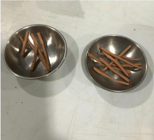
Figura 7. Muestra de suelo agrietada
