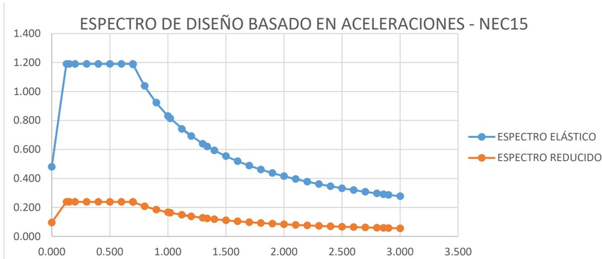
*Nota.* Construcción del espectro de diseño elástico y reducido del suelo tipo D. Elaborado por: Los autores.
