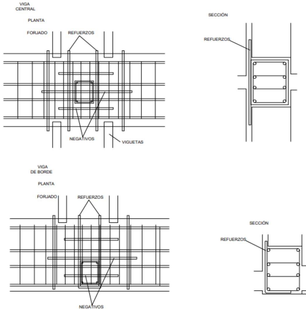
*Nota.* Esquema de viga central y borde. Elaborado por: Los Autores
