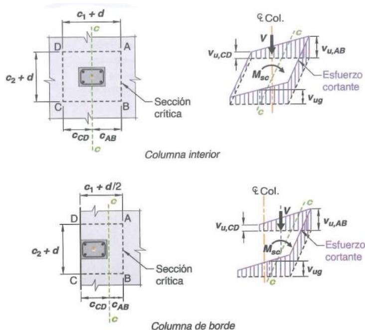
*Nota.* Chequeo por punzonamiento en columna-losa. Fuente: ACI318-19
