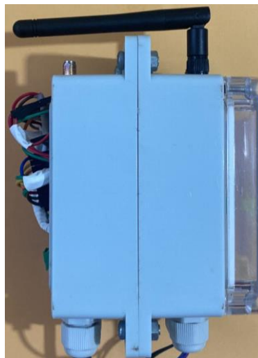
Figura 11: Caja qBox DIY IOT utilizadas en el proyecto.
