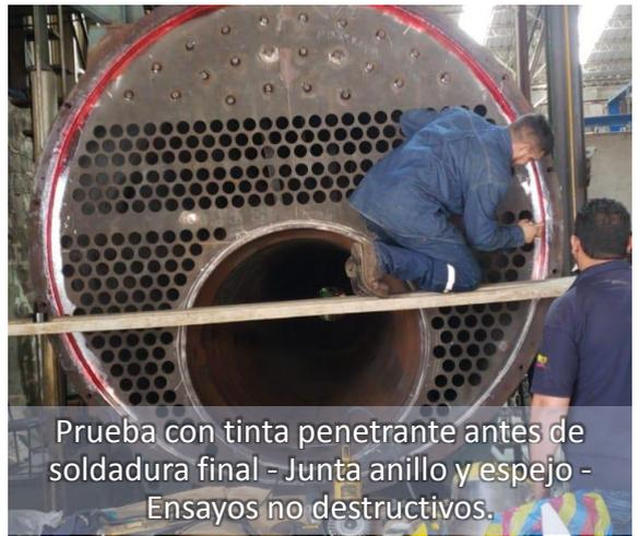
Prueba con tinta penetrante antes de soldadura final - Junta anillo y espejo - Ensayos no destructivos.
