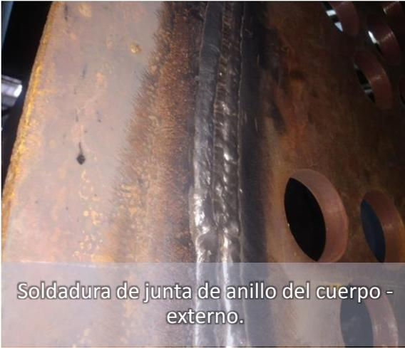
Soldadura de junta de anillo del cuerpo - externo.
