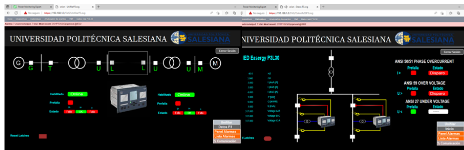
Figura 156: Actuación de las protecciones en el relé P3L30.
