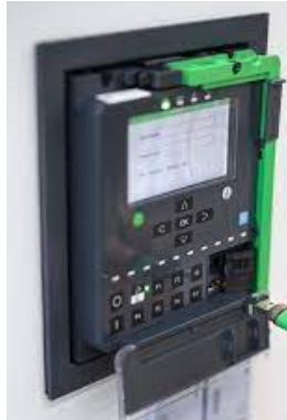
Figura 16: Relé de protección P5F30. Fuente: [8]
