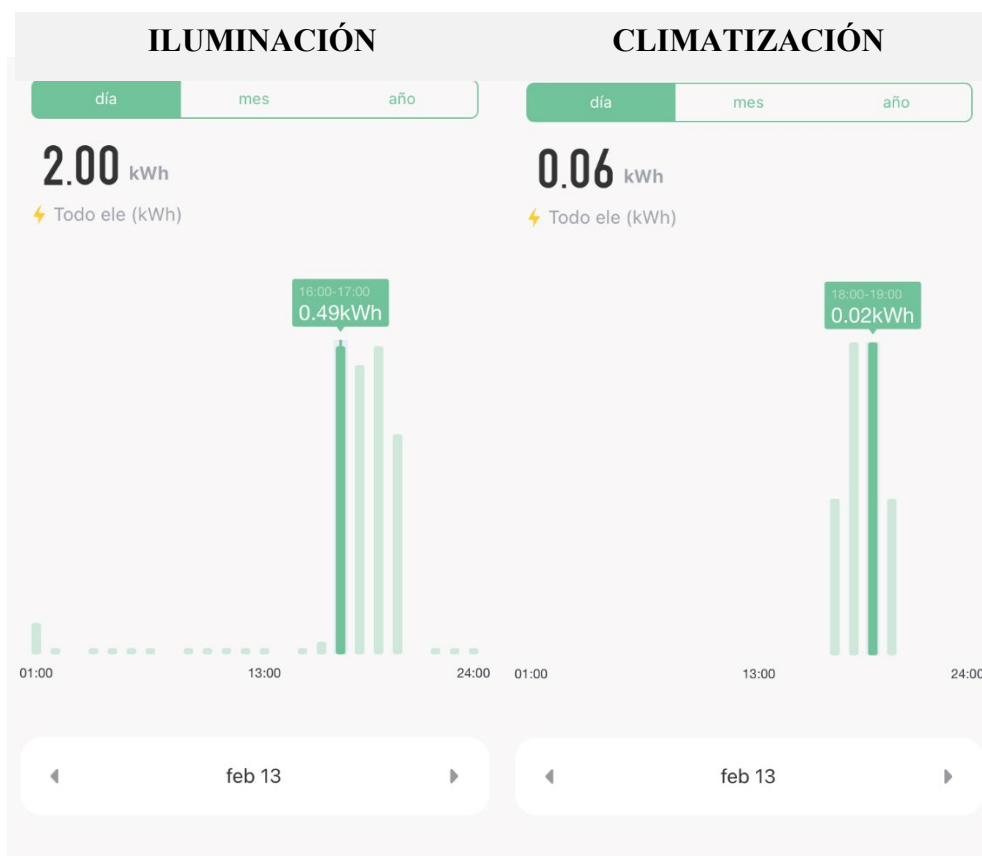
Figura 30. Potencia consumida obtenida por los medidores wifi. Fuente: Autores.
