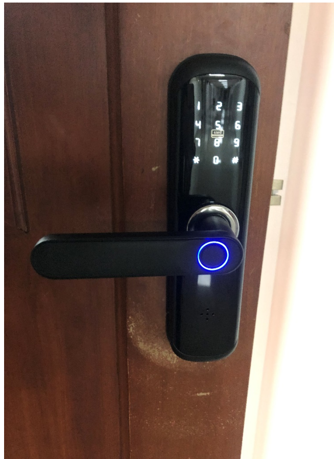
Figura 25. Cerradura biométrica instalada en el laboratorio de generación. Fuente: Autores.
