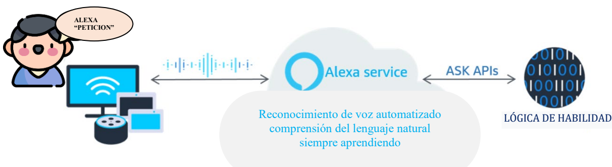
Figura 1. Funcionamiento simplificado de Alexa. Fuente: Autores.
