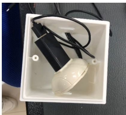
Figura 18. instalación interna del control infrarrojo. Fuente: Autores.
