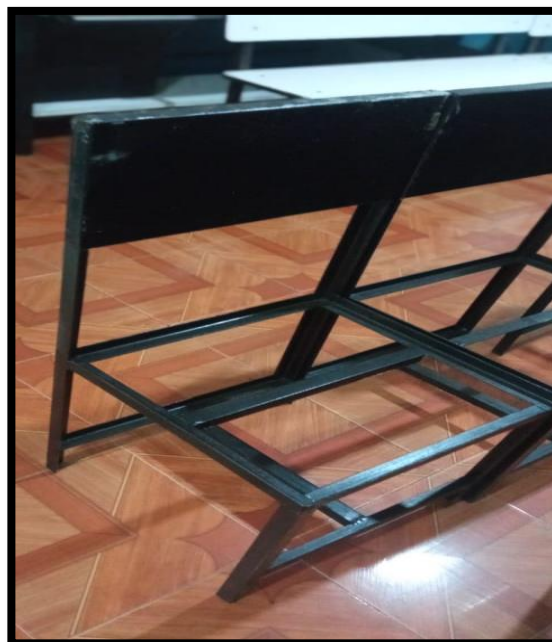
Anexo 15. Construcción de base para baterías
