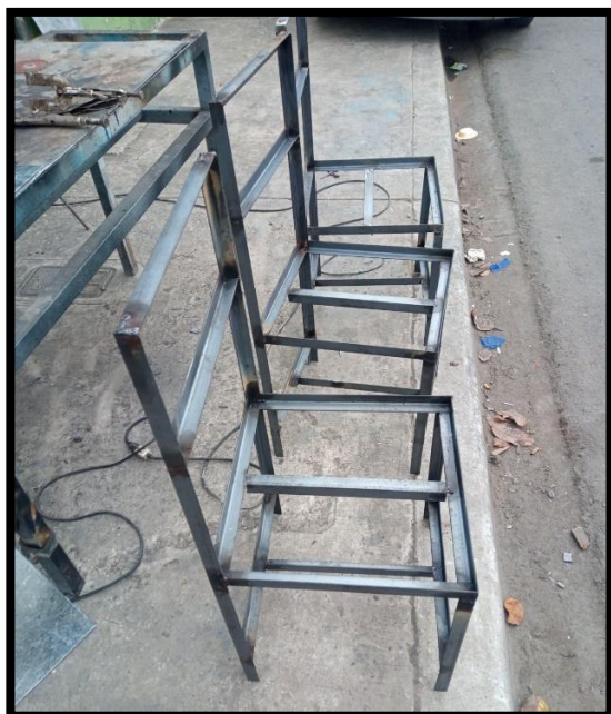
Anexo 15. Construcción de base para baterías
