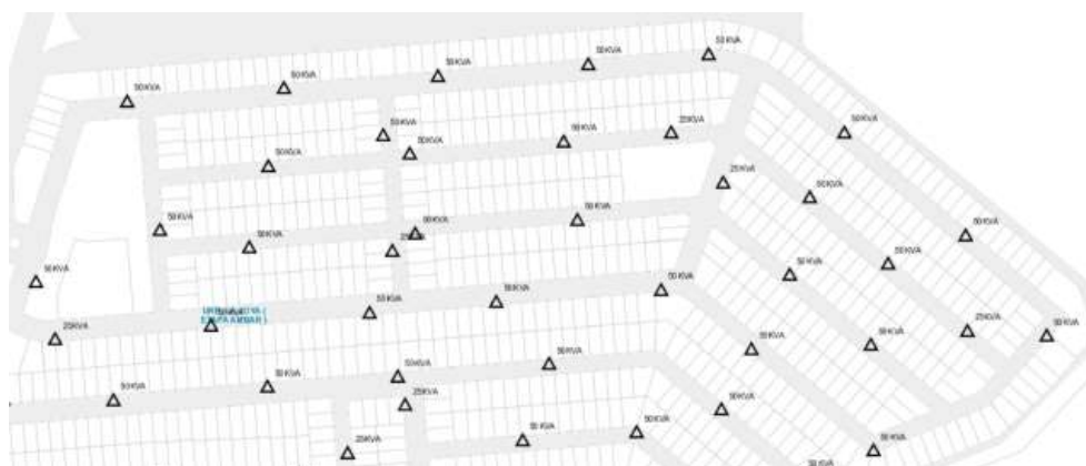
Figura 3.5 Ubicación de transformadores
