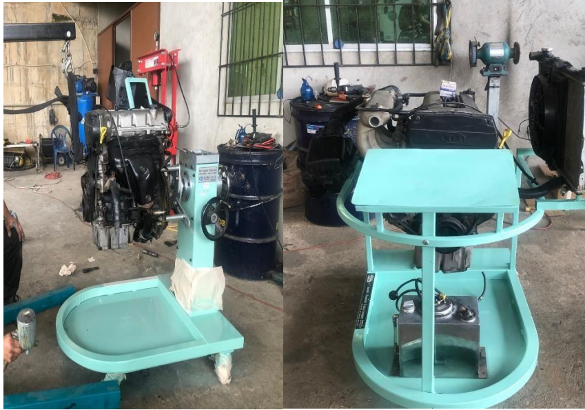
Figura 2.32. Estructura reacondicionada del banco didáctico del motor KIA 1.8 T8D.
