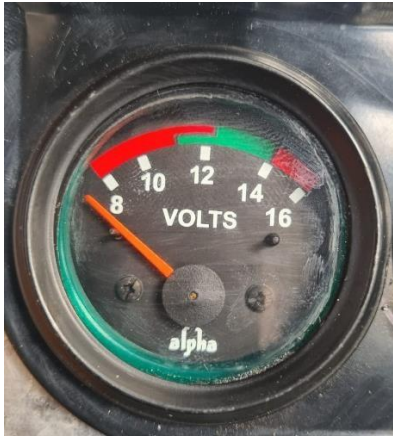
Figura 2.37. Medidor de Voltaje.
