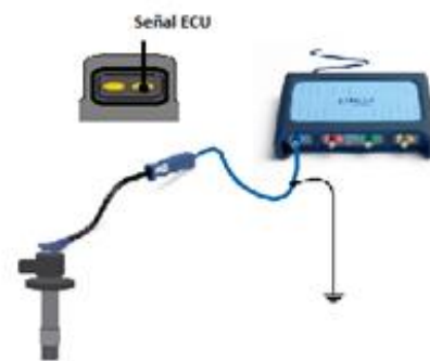
Fig 4. Conexión osciloscopio a la bobina de encendido.
