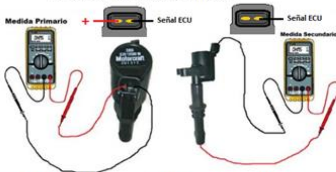
Fig 3. Medición resistencia circuito primario y secundario.
